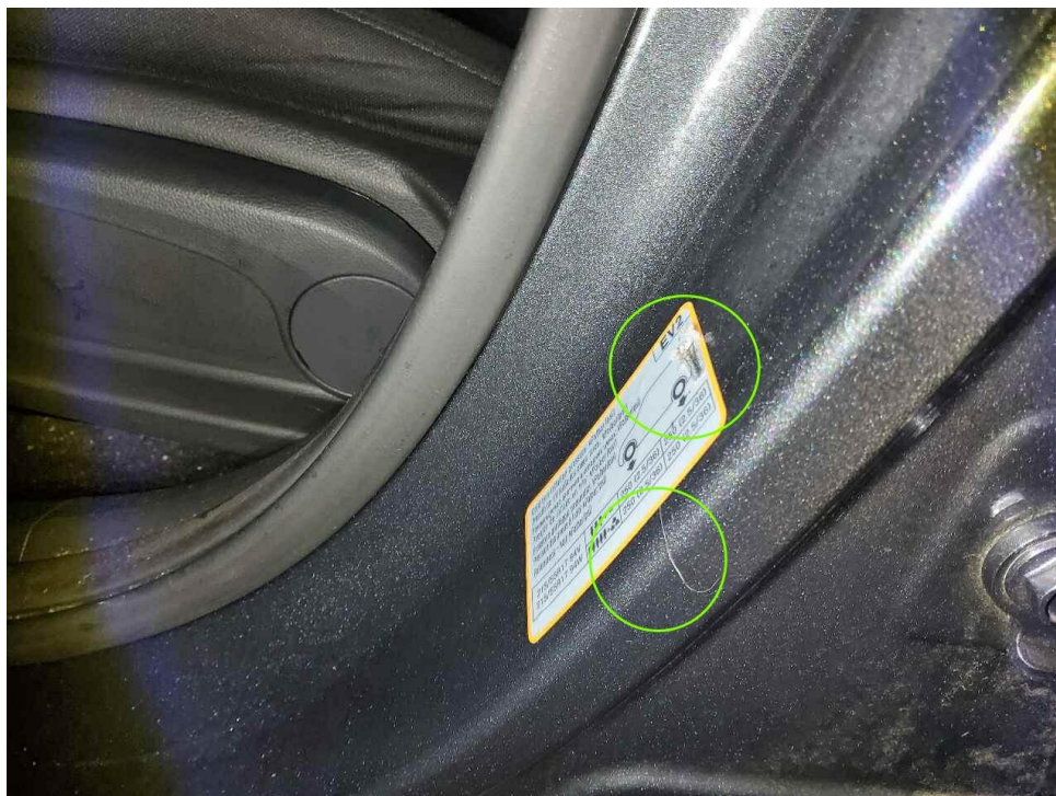
Bild 12 : Türeinstieg vorne links verschrammt und eingedellt, Aufkleber Reifendruck beschädigt
