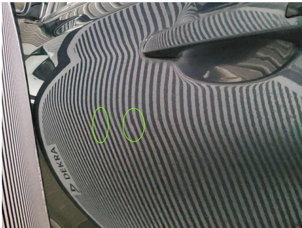
Bild 13 : Tür vorne links mehrfach eingedellt
