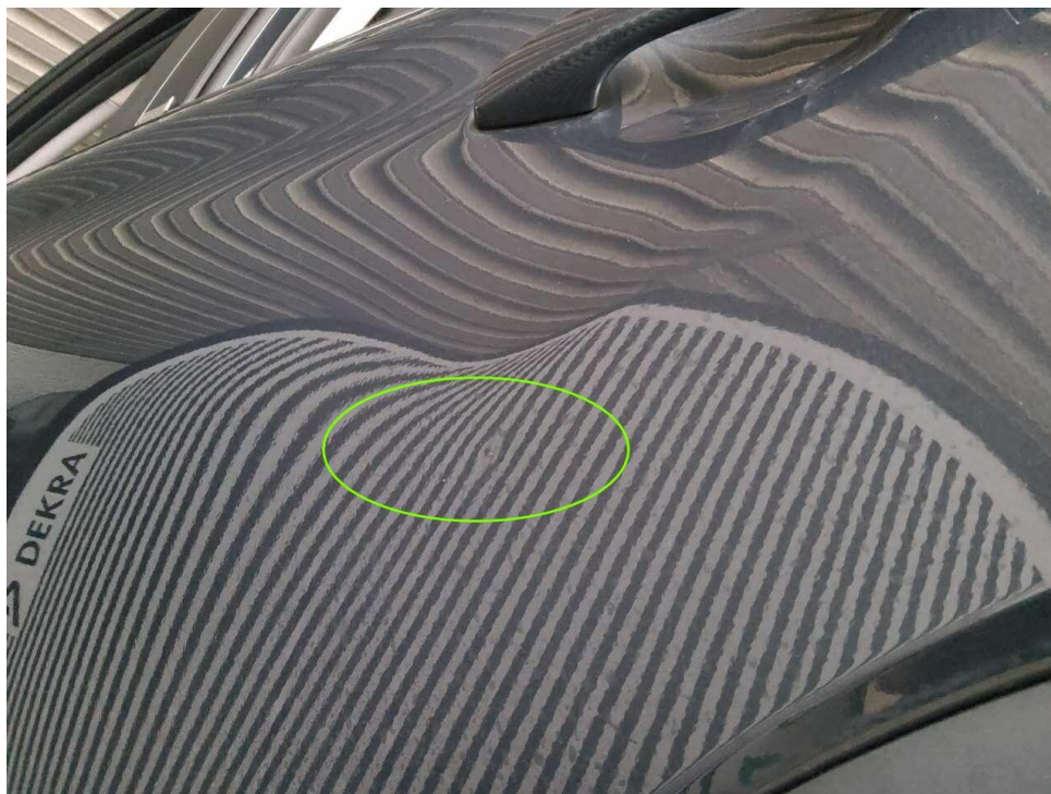
Bild 15 : Tür hinten links eingedellt
