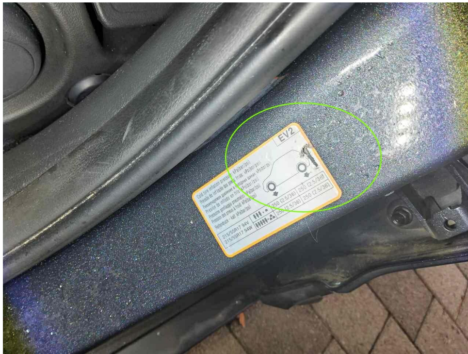
Bild 11 : Türeinstieg vorne links verschrammt und eingedellt, Aufkleber Reifendruck beschädigt
