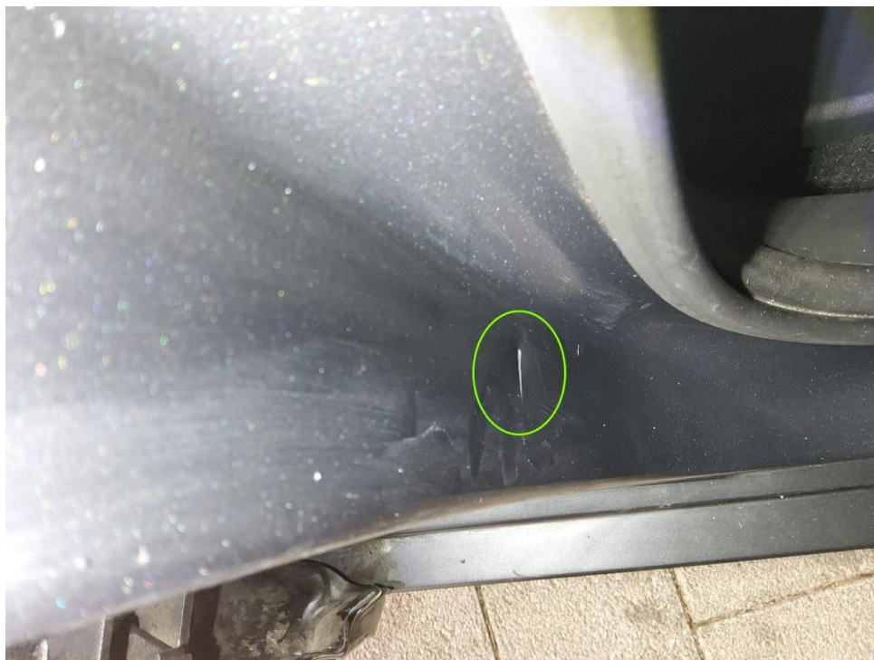
Bild 7 : Türeinstieg vorne rechts verschrammt und eingedellt
