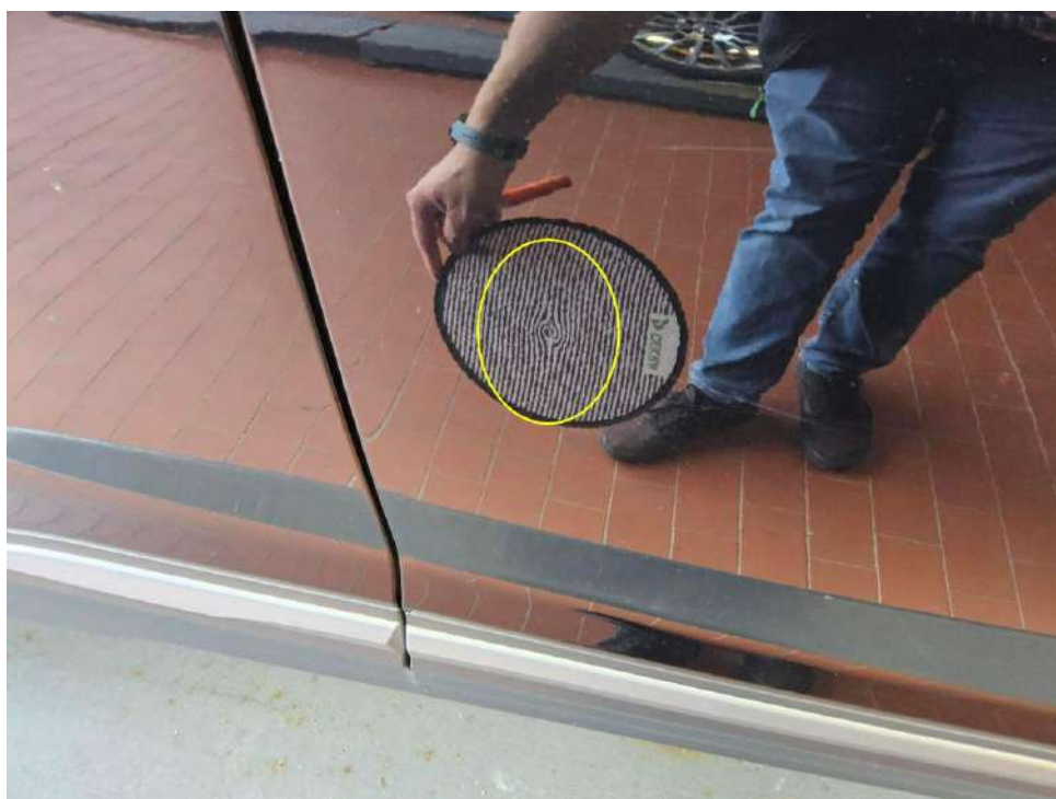
Bild 28 : Tür vorne rechts, eingedellt, drücken
