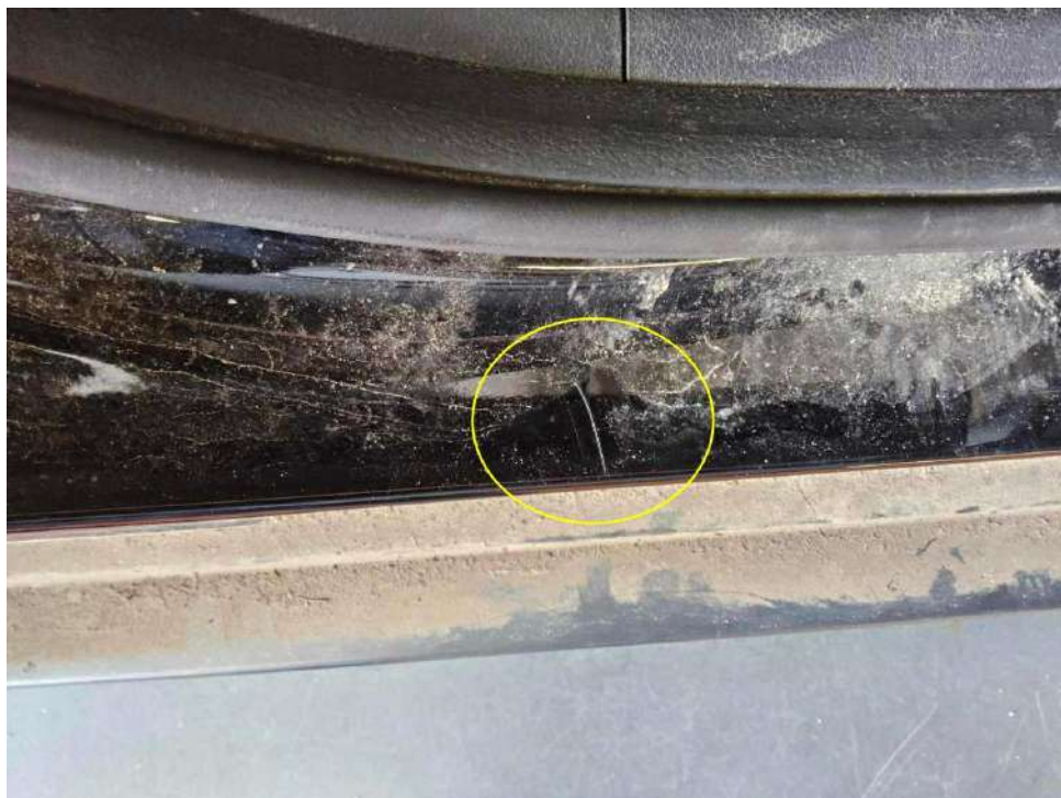
Bild 30 : Tür vorne rechts Einstieg Lackierung, zerkratzt, smartr repair
