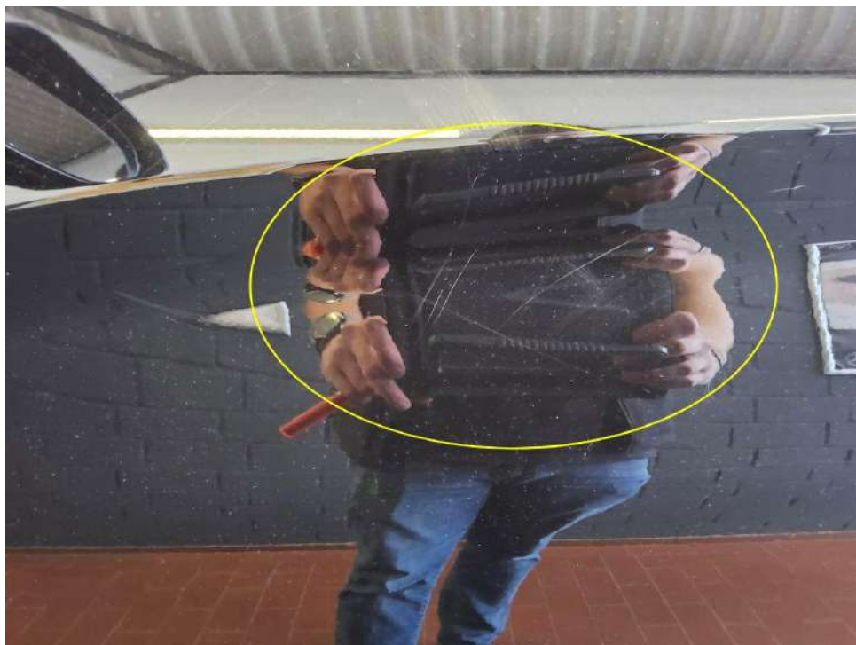
Bild 26 : Tür vorne links, eingedellt, instandsetzen und lackieren mit Lackaufbau
