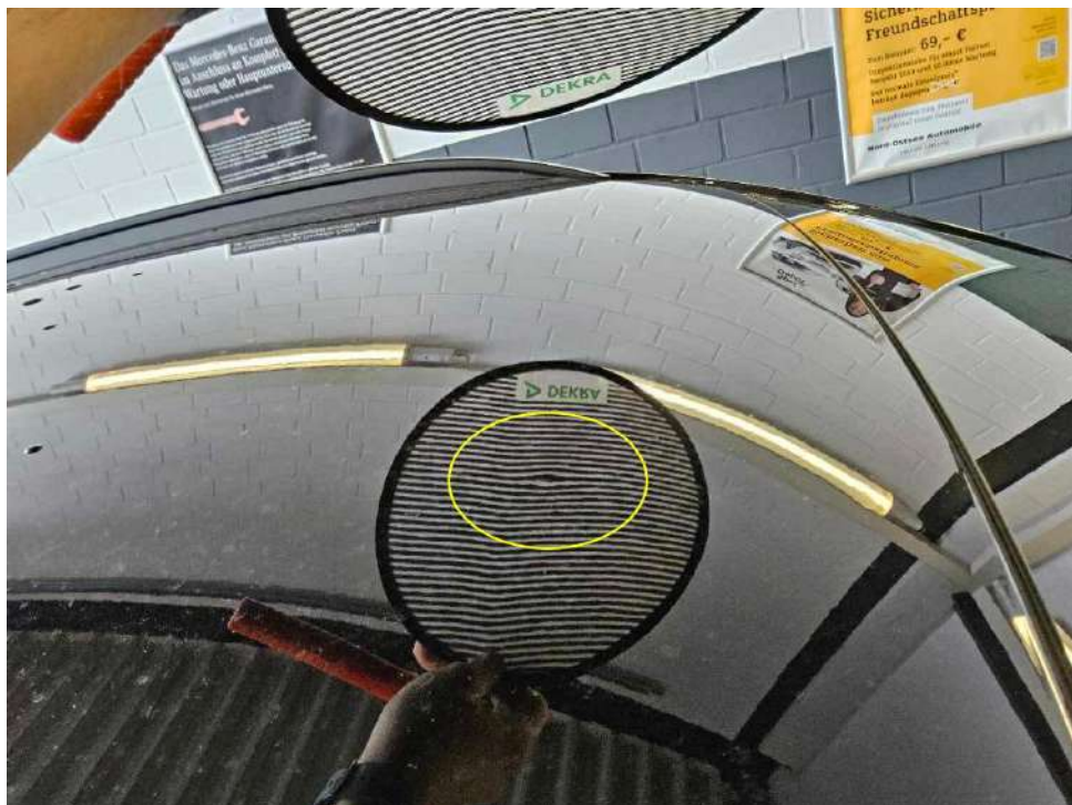
Bild 20 : Dach / Motorhaube Hagelschaden
