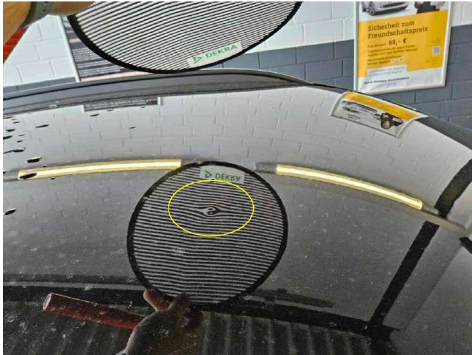
Bild 19 : Dach / Motorhaube Hagelschaden
