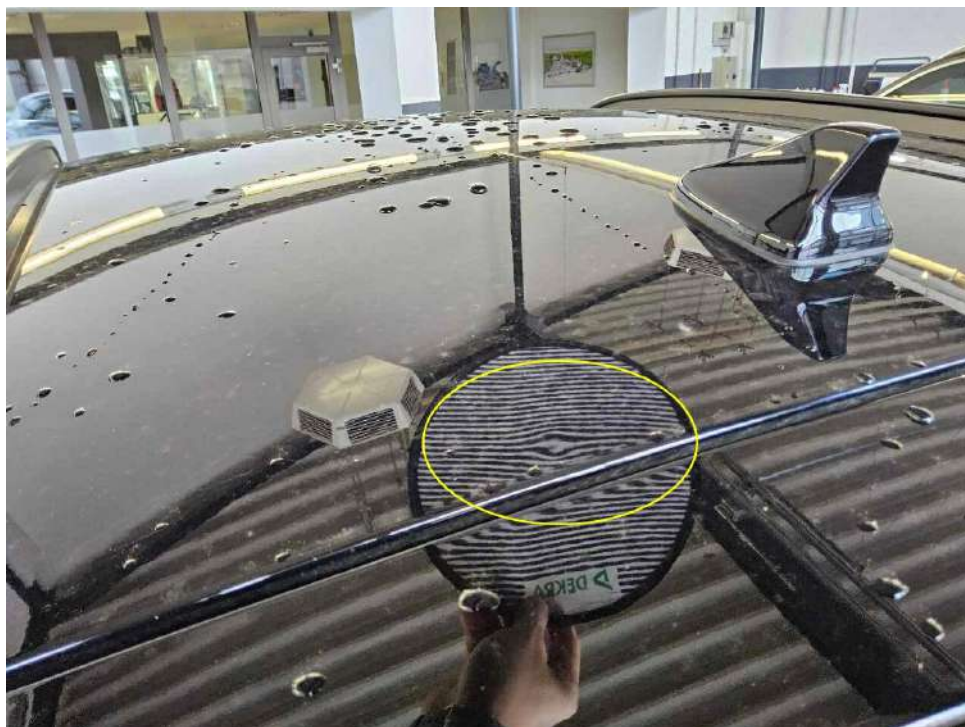
Bild 24 : Dach / Motorhaube Hagelschaden
