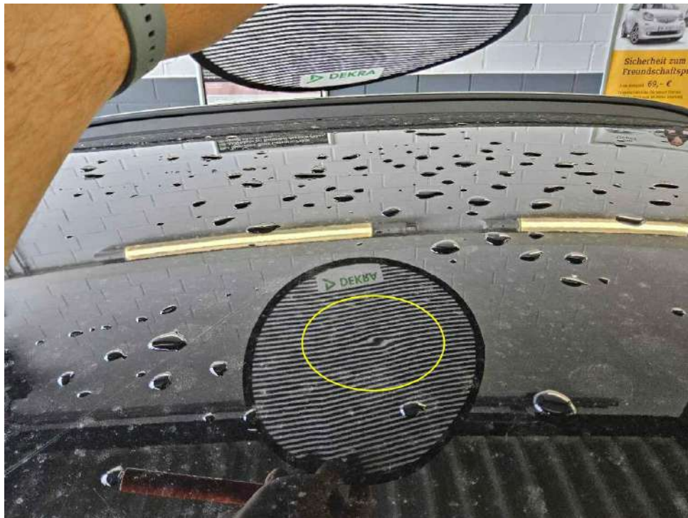
Bild 21 : Dach / Motorhaube Hagelschaden
