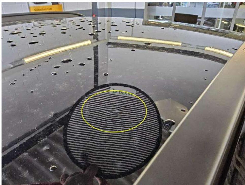
Bild 23 : Dach / Motorhaube Hagelschaden
