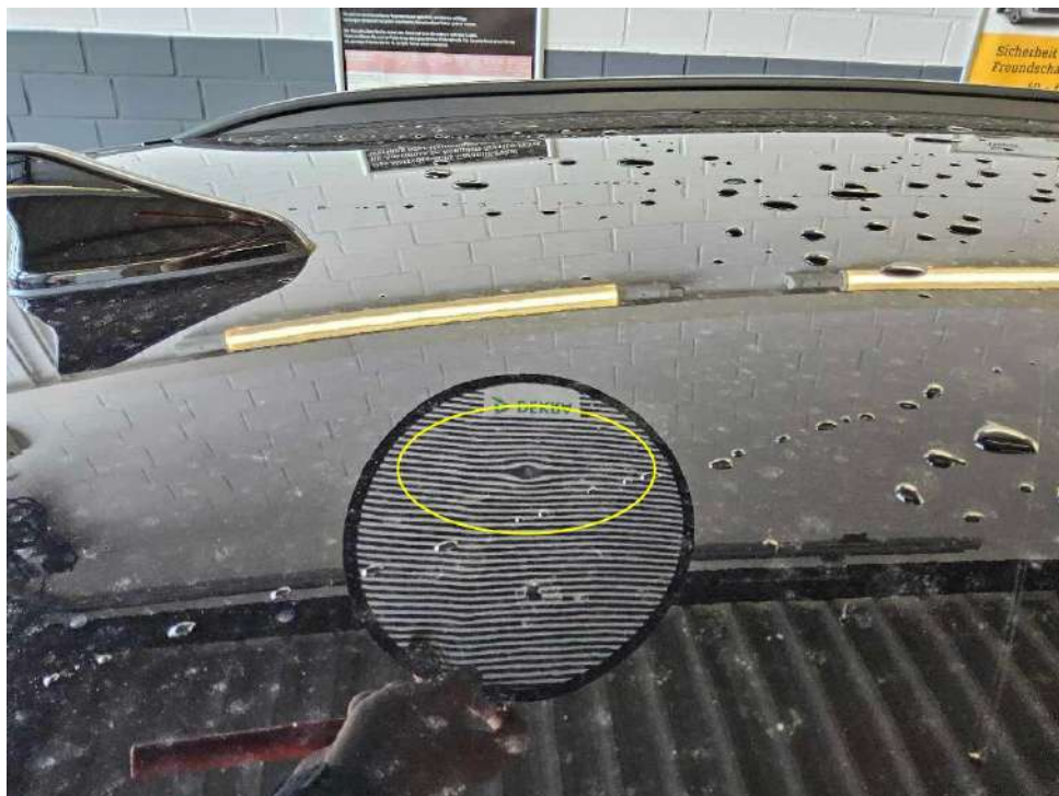
Bild 22 : Dach / Motorhaube Hagelschaden
