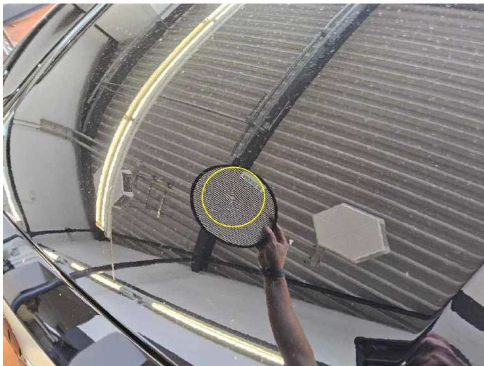
Bild 15 : Dach / Motorhaube Hagelschaden
