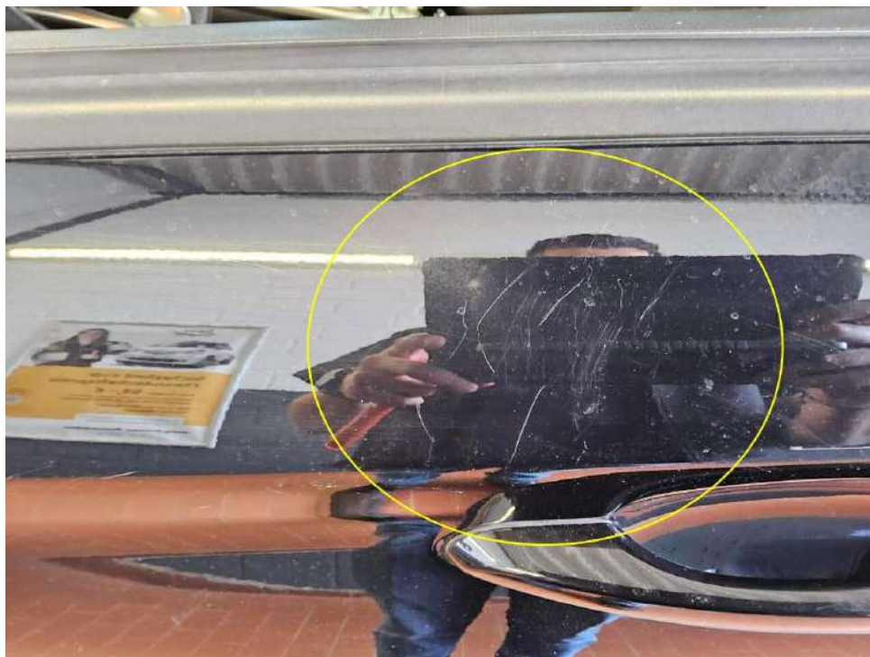
Bild 27 : Tür vorne links, eingedellt, instandsetzen und lackieren mit Lackaufbau
