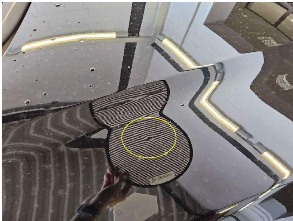
Bild 17 : Dach / Motorhaube Hagelschaden
