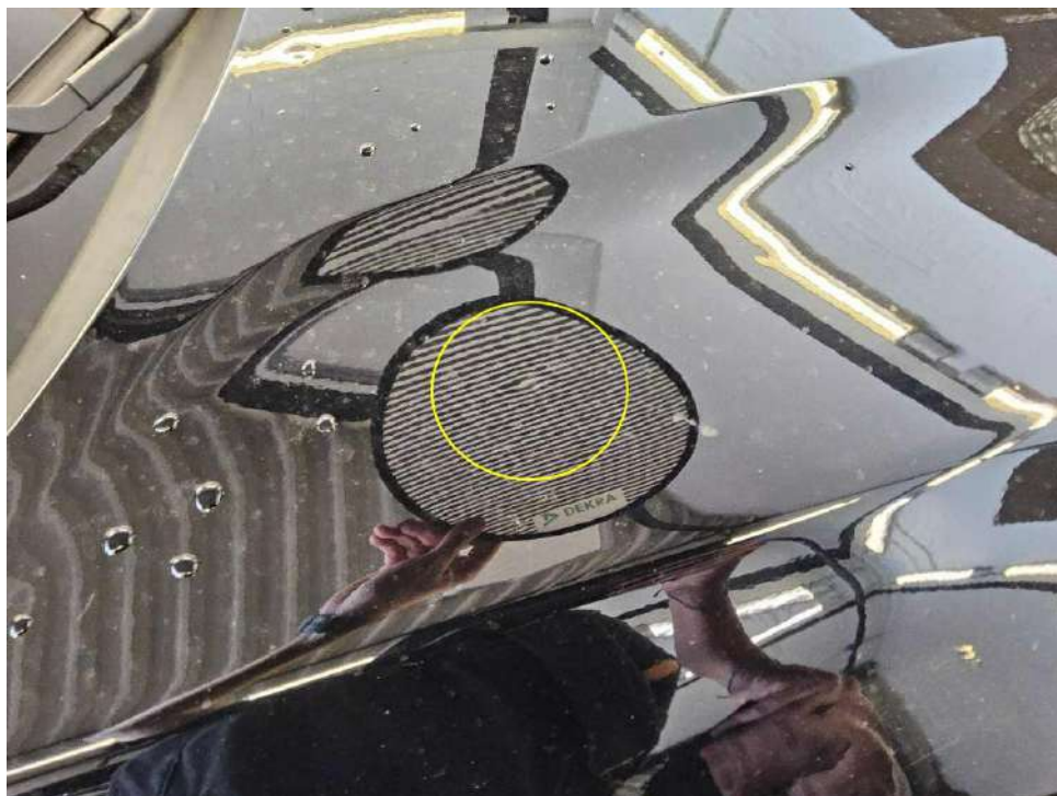
Bild 18 : Dach / Motorhaube Hagelschaden
