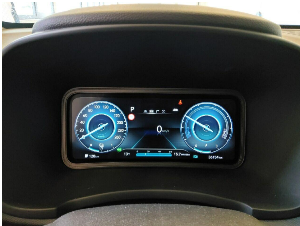
Bild 4 : Kombiinstrument (betriebsbereit) mit Km-Stand
