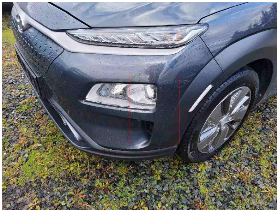
Bild 10 : Stoßfänger vorne Lackierung, zerkratzt, lackieren
