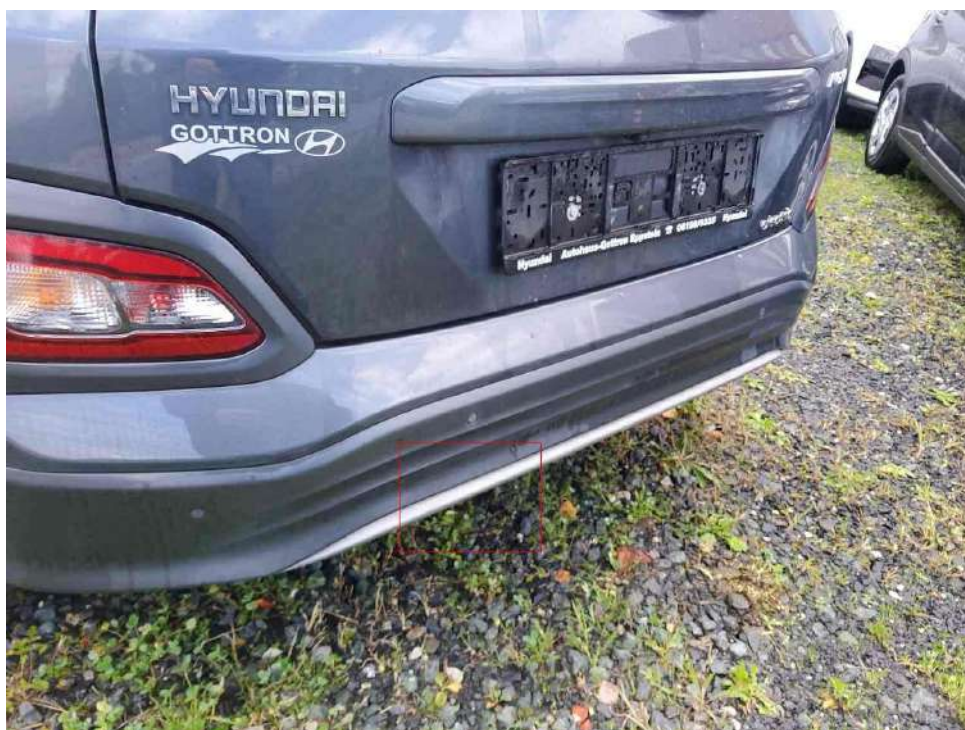
Bild 12 : Stoßfänger hinten Unterfahrschutz beschädigt (Druckstelle)
