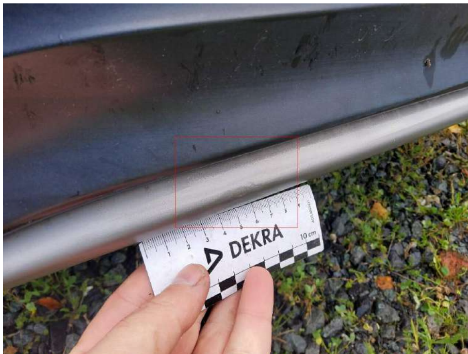
Bild 13 : Stoßfänger hinten Unterfahrschutz beschädigt (Druckstelle)
