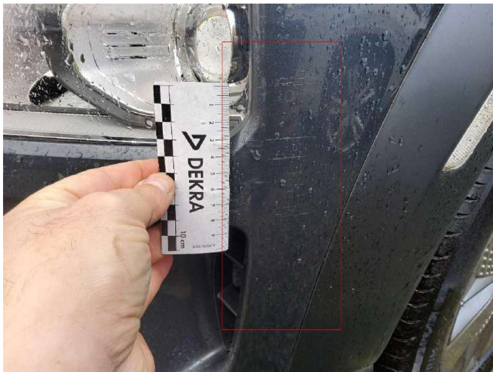
Bild 11 : Stoßfänger vorne Lackierung, zerkratzt, lackieren
