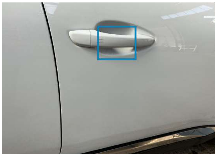
17. Porte Avant Droite Peinture Rayure Ligne -
