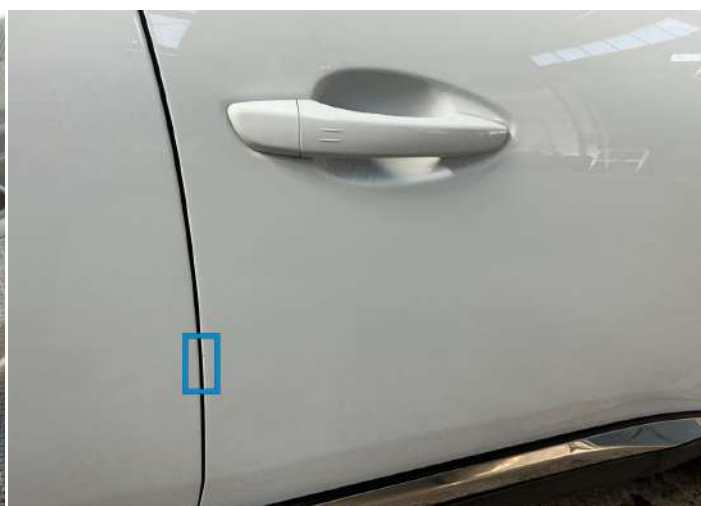
28. Porte Avant Droite Peinture Rayure Ligne -
