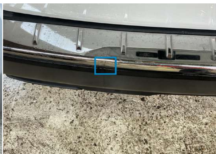
24. Pare chocs Arrière Enfoncement -
