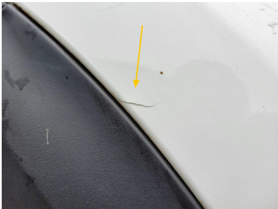
Bild 8 : Stoßfänger vorne gebrochen
