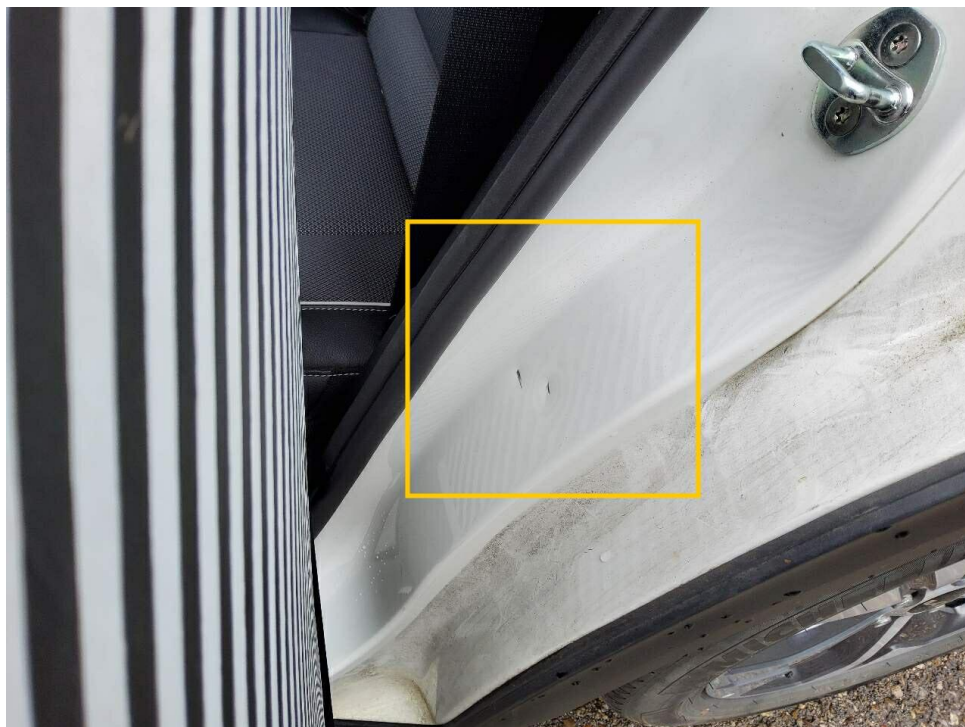
Bild 10 : Einstieg hinten links verschrammt und eingedellt
