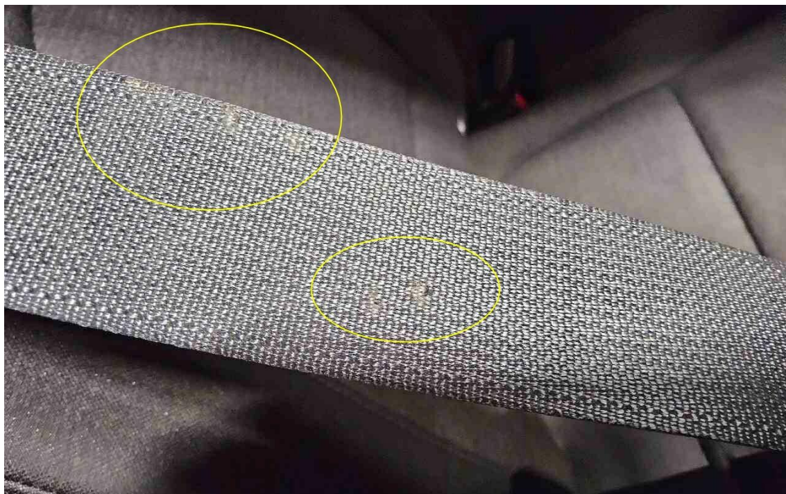
Bild 12 : Sicherheitsgurt hinten rechts beschädigt
