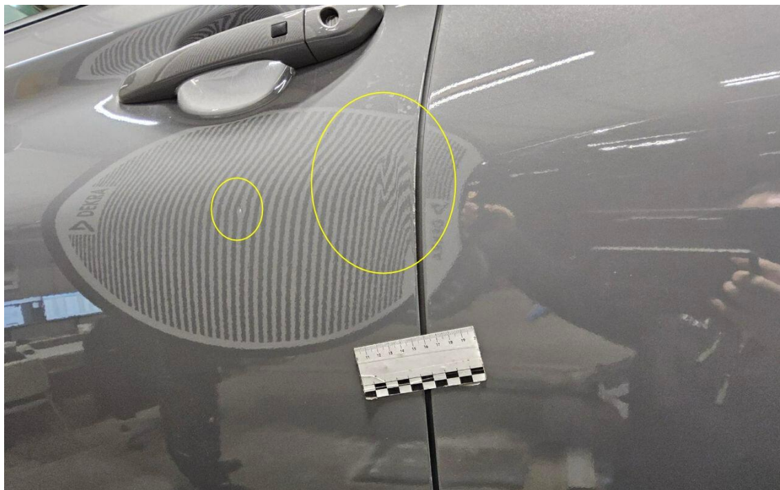
Bild 7 : Tür vorne links, mehrfach eingedellt, instandsetzen und lackieren mit Lackaufbau
