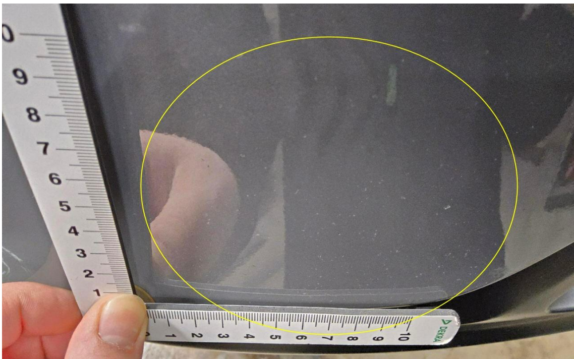
Bild 10 : Stoßfänger vorne Lackierung, viele Steinschläge, lackieren
