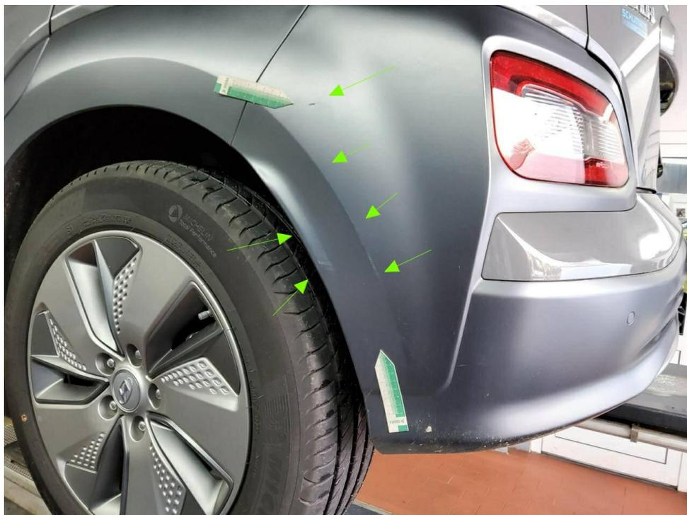
Bild 14 : Stoßfänger hinten Lackierung, zerkratzt, lackieren mit Lackaufbau
