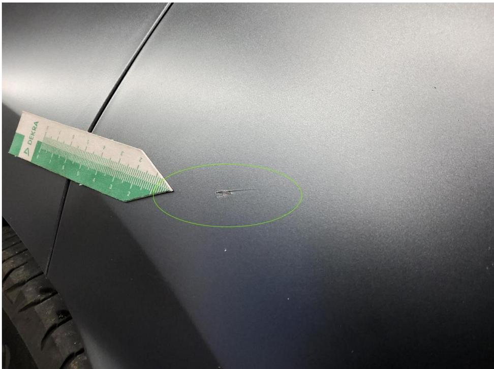
Bild 12 : Stoßfänger hinten Lackierung, zerkratzt, lackieren mit Lackaufbau
