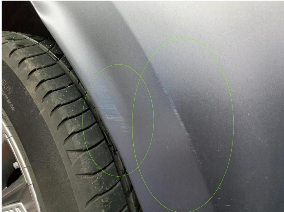
Bild 13 : Stoßfänger hinten Lackierung, zerkratzt, lackieren mit Lackaufbau
