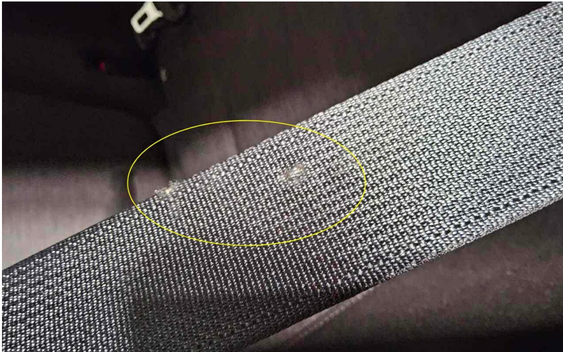
Bild 9 : Sicherheitsgurt hinten links beschädigt
