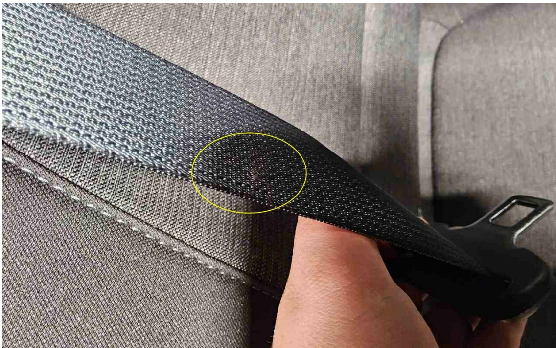
Bild 8 : Sicherheitsgurt hinten rechts beschädigt
