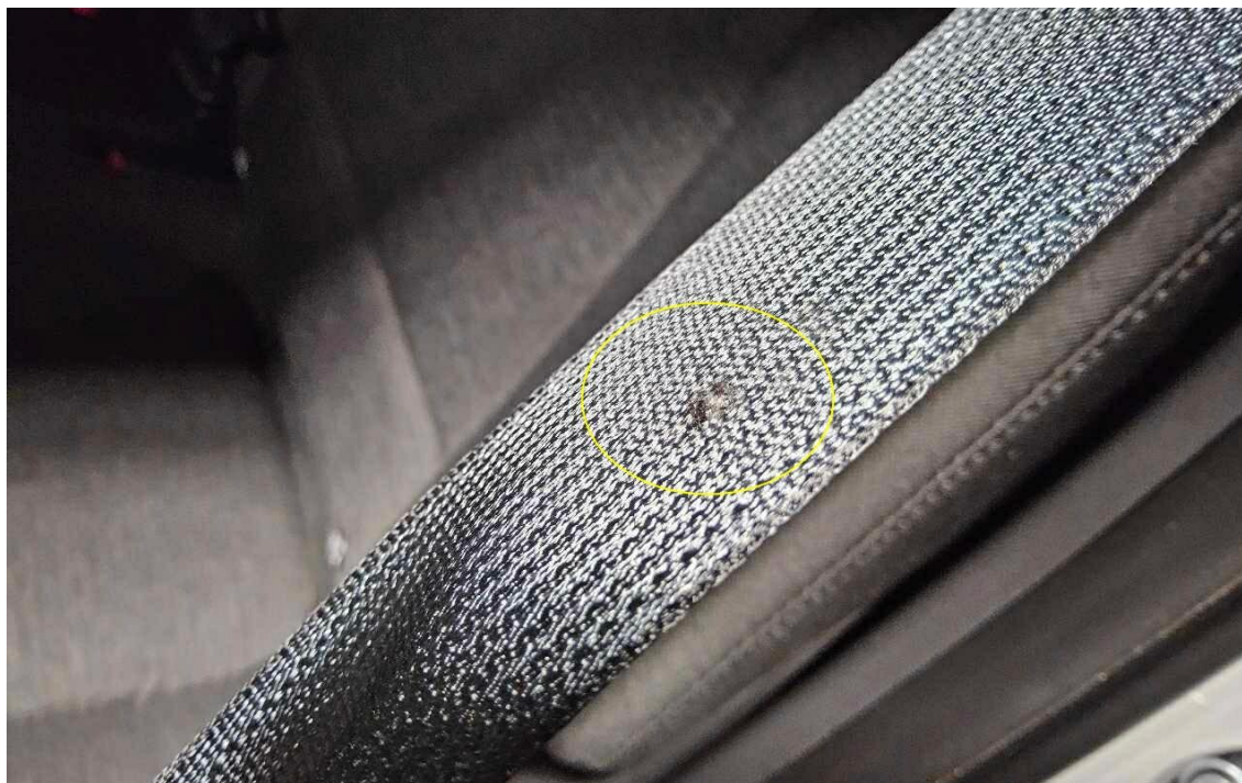
Bild 9 : Sicherheitsgurt hinten links beschädigt
