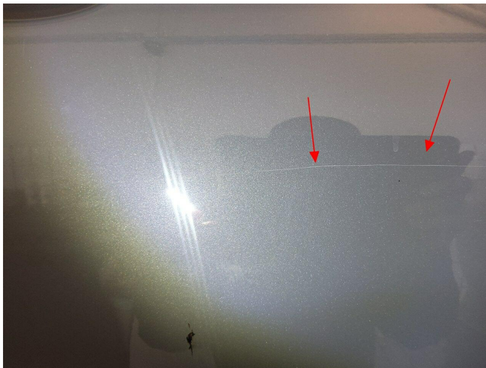
Bild 12 : Tür vorne rechts, mehrfach eingedellt, instandsetzen und lackieren mit Lackaufbau
