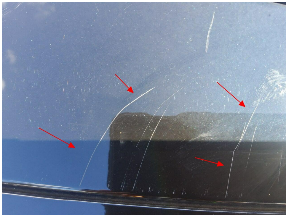
Bild 20 : Heckklappe Lackierung, zerkratzt, lackieren mit Lackaufbau
