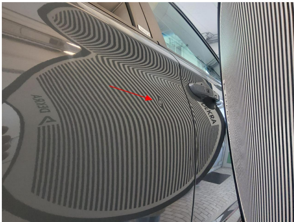
Bild 13 : Tür hinten rechts, eingedellt, drücken
