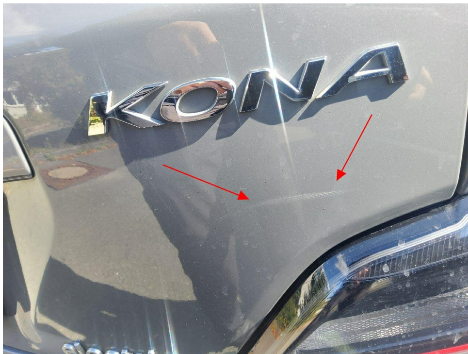
Bild 21 : Heckklappe Lackierung, zerkratzt, lackieren mit Lackaufbau
