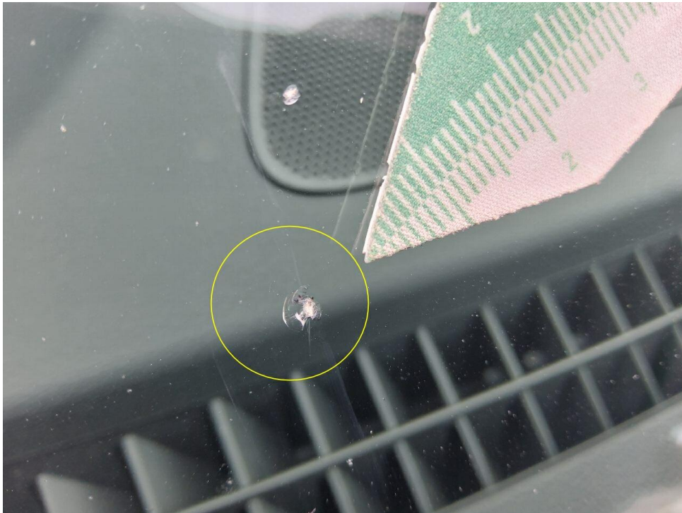
Bild 9 : Windschutzscheibe Steinschlag beschädigt
