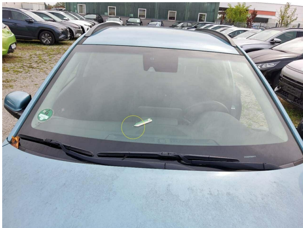
Bild 8 : Windschutzscheibe Steinschlag beschädigt
