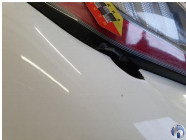
5. Rückleuchte Links Beschädigt - Erneuern 248,00 € / 248,00 €
