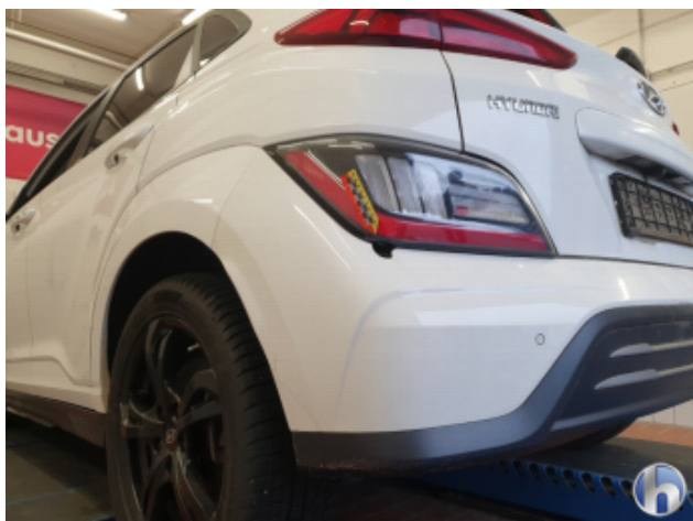
5. Rückleuchte Links Beschädigt - Erneuern 248,00 € / 248,00 €
