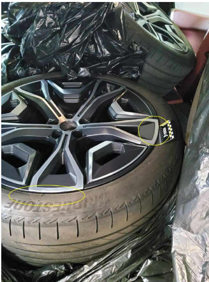
Bild 12 : Felge hinten rechts Kratzer
