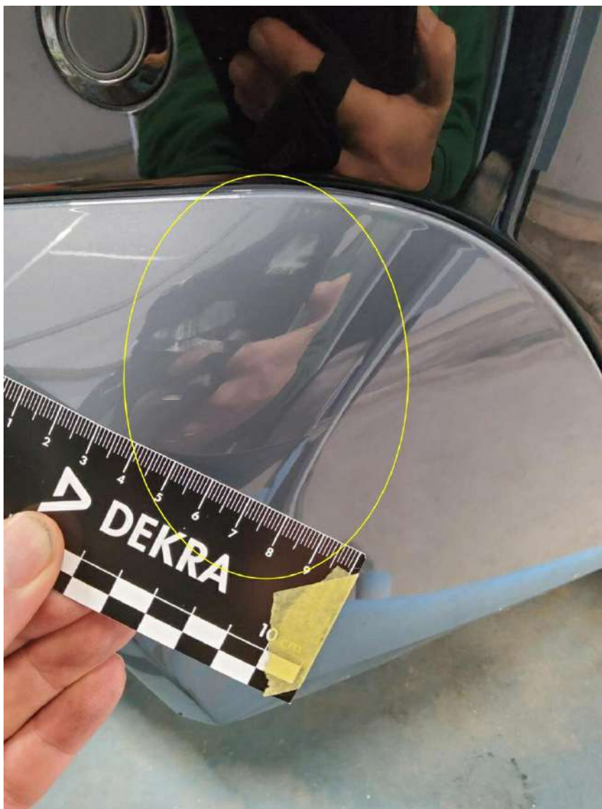
Bild 7 : Stoßfänger hinten, Kratzer , lackieren mit Lackaufbau
