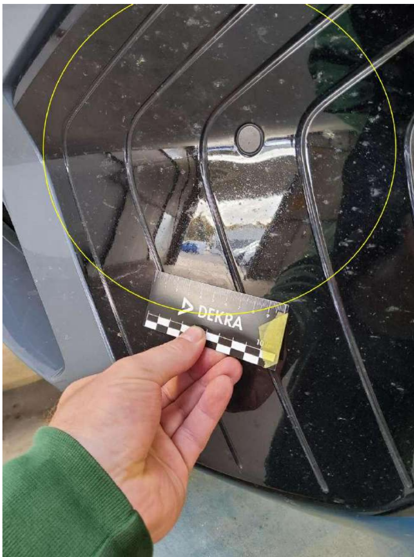
Bild 9 : Stoßfänger vorne, Steinschlag , lackieren mit Lackaufbau
