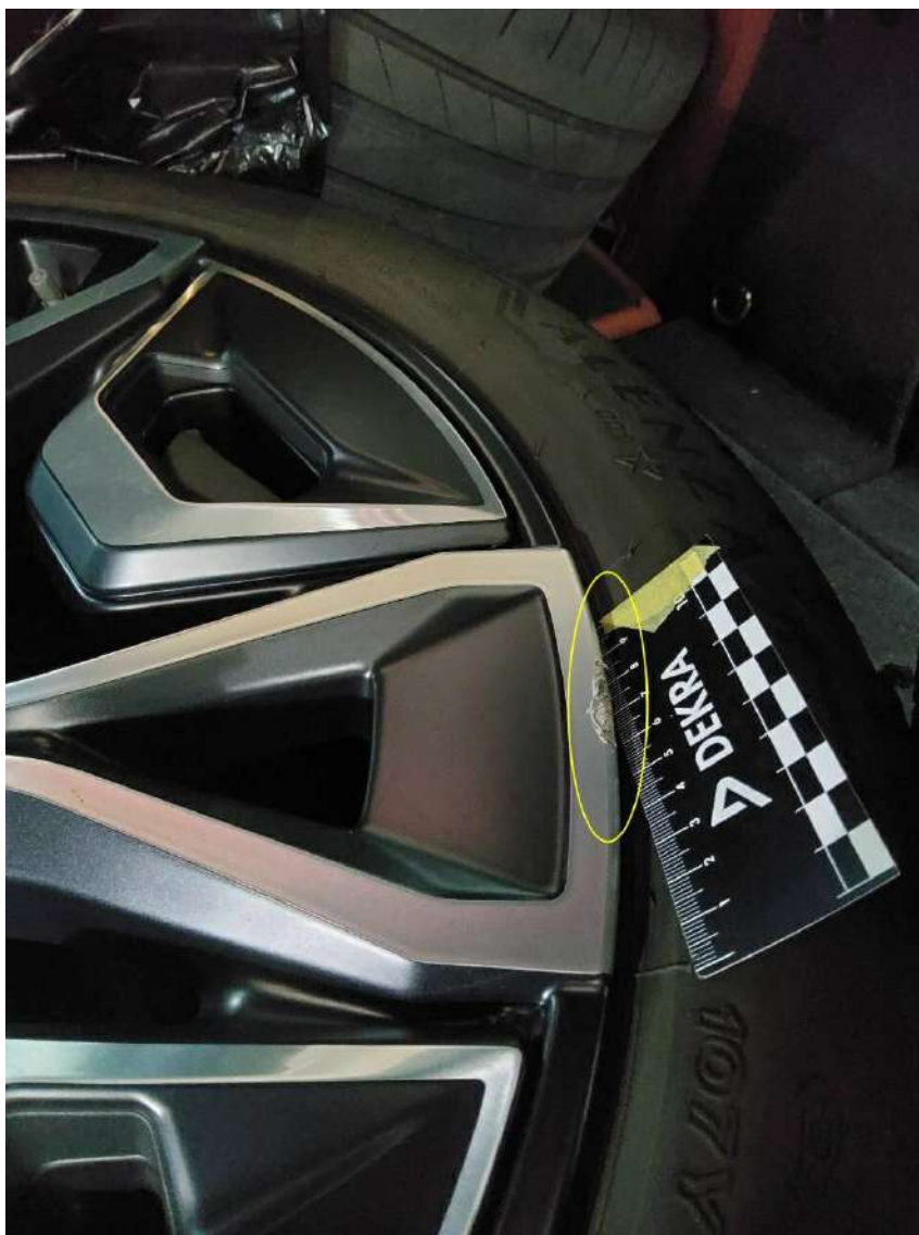
Bild 11 : Felge hinten rechts Kratzer
