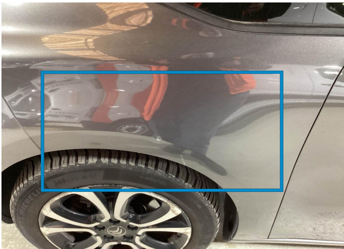
13. Aile Avant Gauche Enfoncement Bosse -
