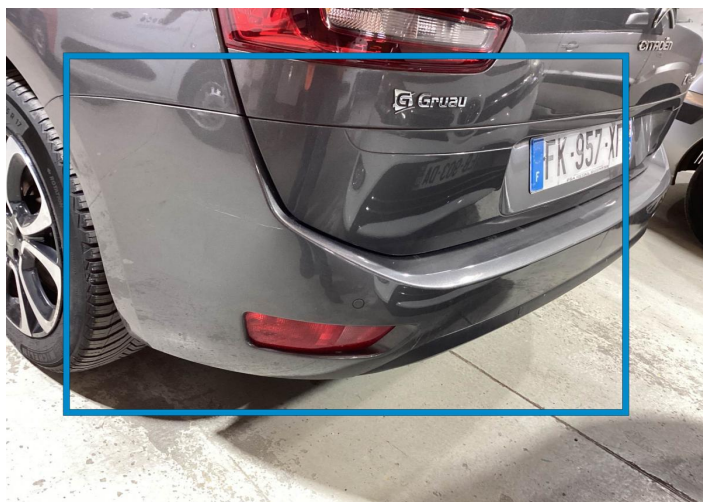
1. Coin de pare chocs Arrière Gauche Peinture Rayure Bandes - Griffes -
