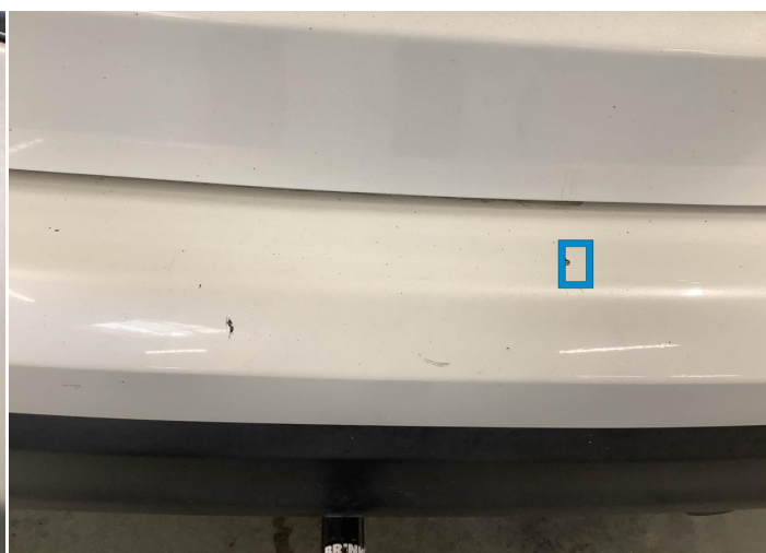
4. Pare chocs Arrière Peinture Ecaillage -
