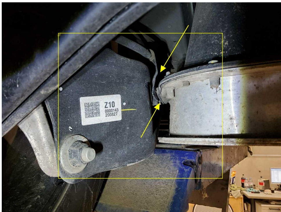
Bild 12 : Heckschaden gem Gutachten instandsetzen (Kalkulation überschlägig) Längslenker links gestaucht, Batteriegehäuse dadurch beschädigt
