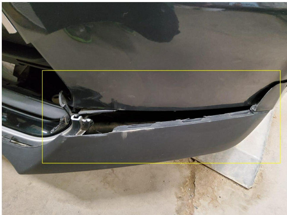
Bild 16 : Heckschaden gem Gutachten instandsetzen (Kalkulation überschlägig)
