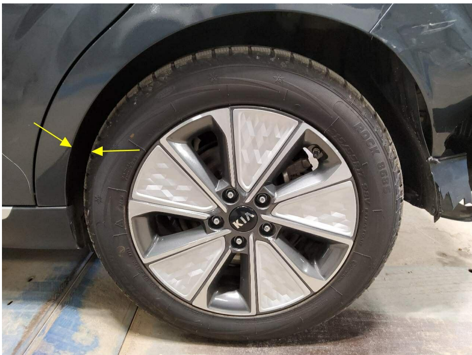
Bild 10 : Heckschaden gem Gutachten instandsetzen (Kalkulation überschlägig) Rad hinten links verschoben
