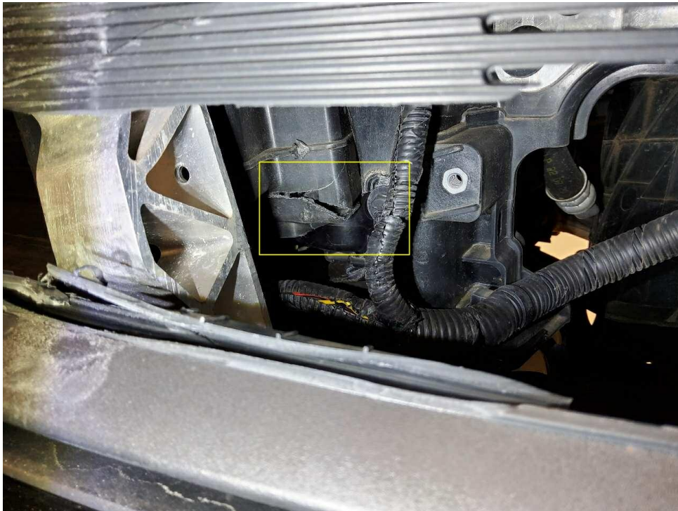
Bild 21 : Heckschaden gem Gutachten instandsetzen (Kalkulation überschlägig) Kühler gebrochen
