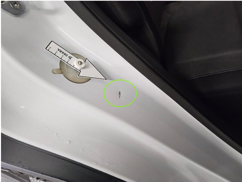
Bild 11 : Tür hinten rechts Einstieg, eingedellt, smart repair
