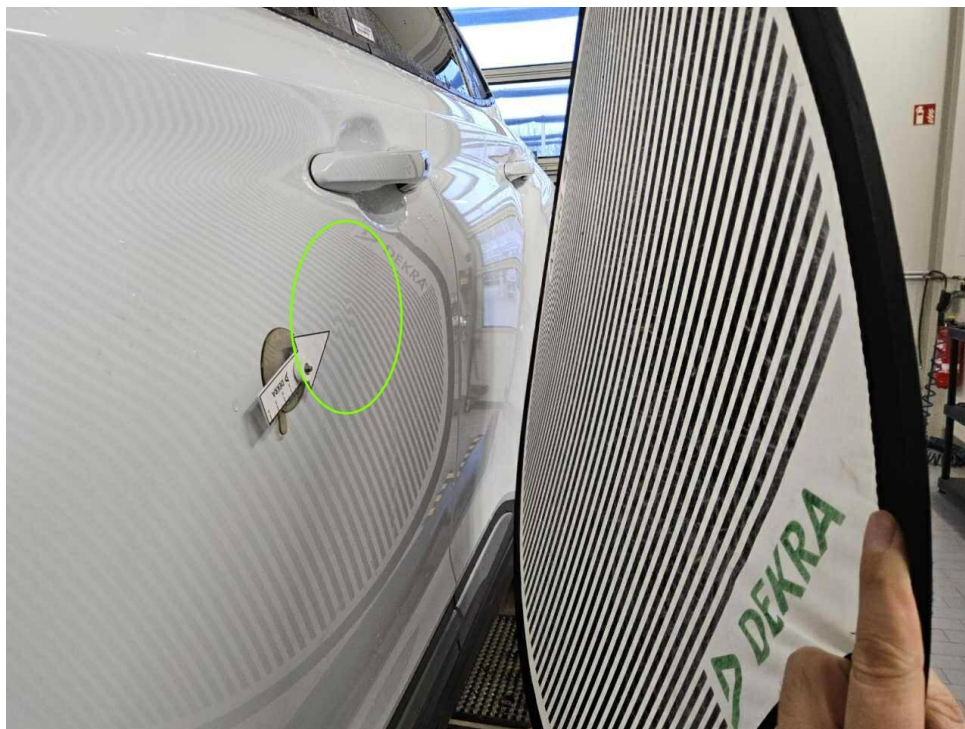
Bild 7 : Tür vorne links, mehrfach eingedellt, drücken
