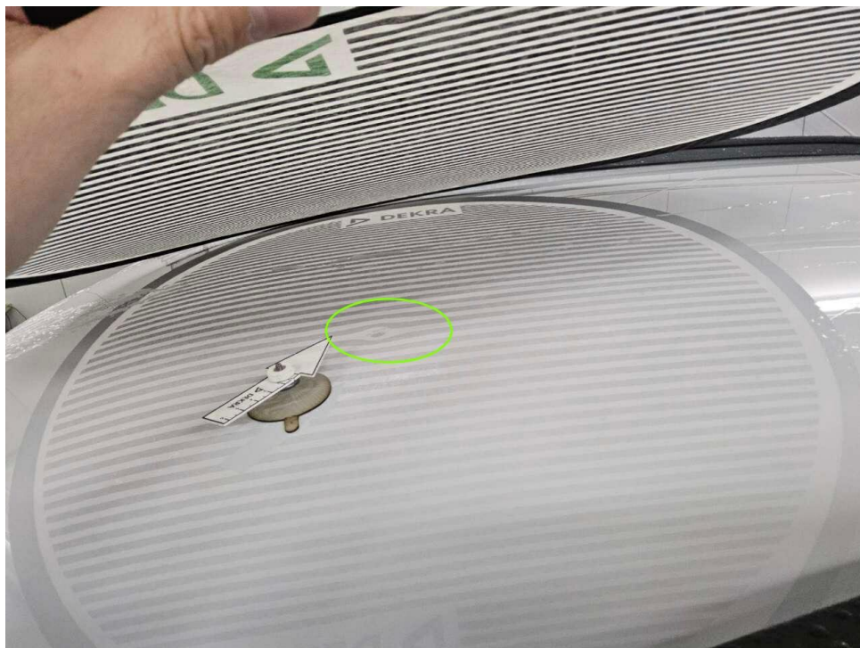
Bild 10 : Dach, mehrfach eingedellt, drücken
