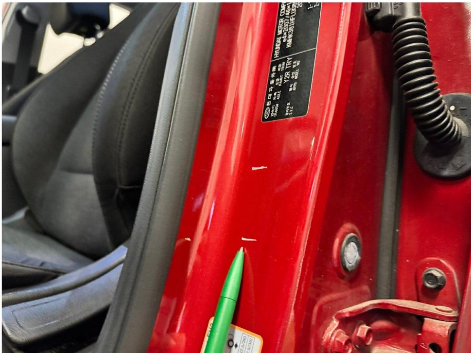
Bild 12 : Einstieg vorne links Kratzer + Delle
