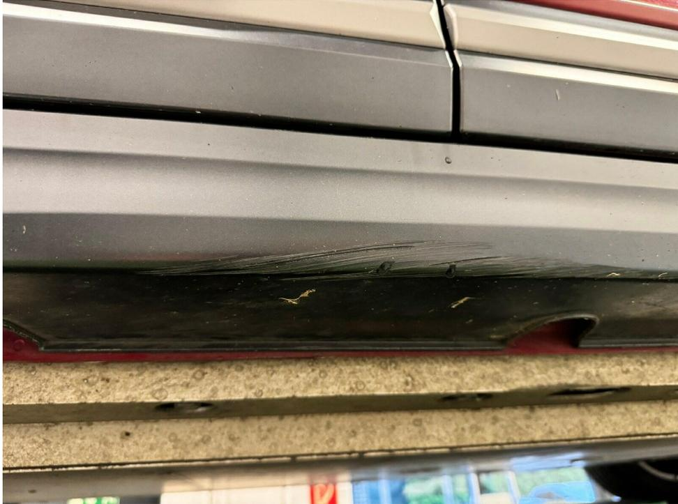
Bild 15 : Schweller rechts Kratzer
