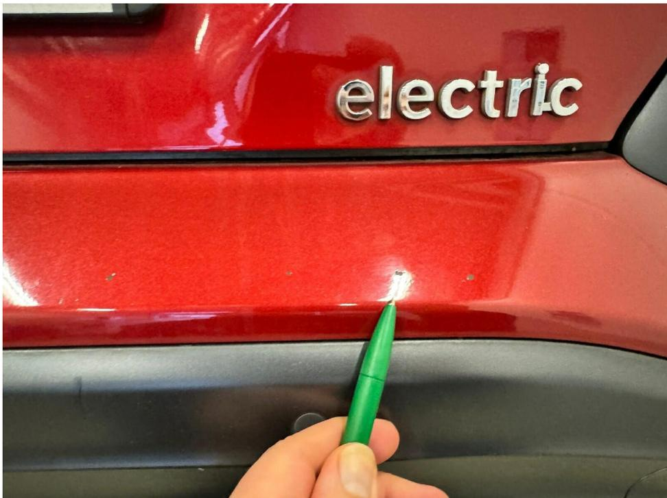
Bild 10 : Stoßfänger hinten Kratzer
