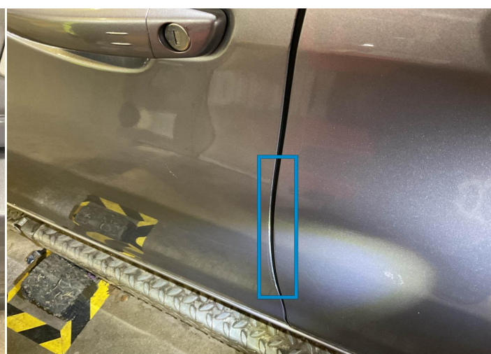
10. Porte Avant Gauche Peinture Rayure Ligne -
