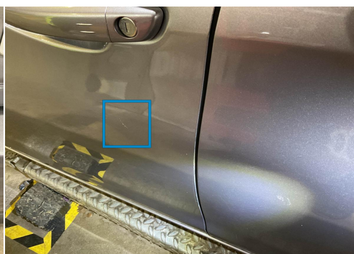
12. Porte Avant Gauche Peinture Rayure Ligne -
