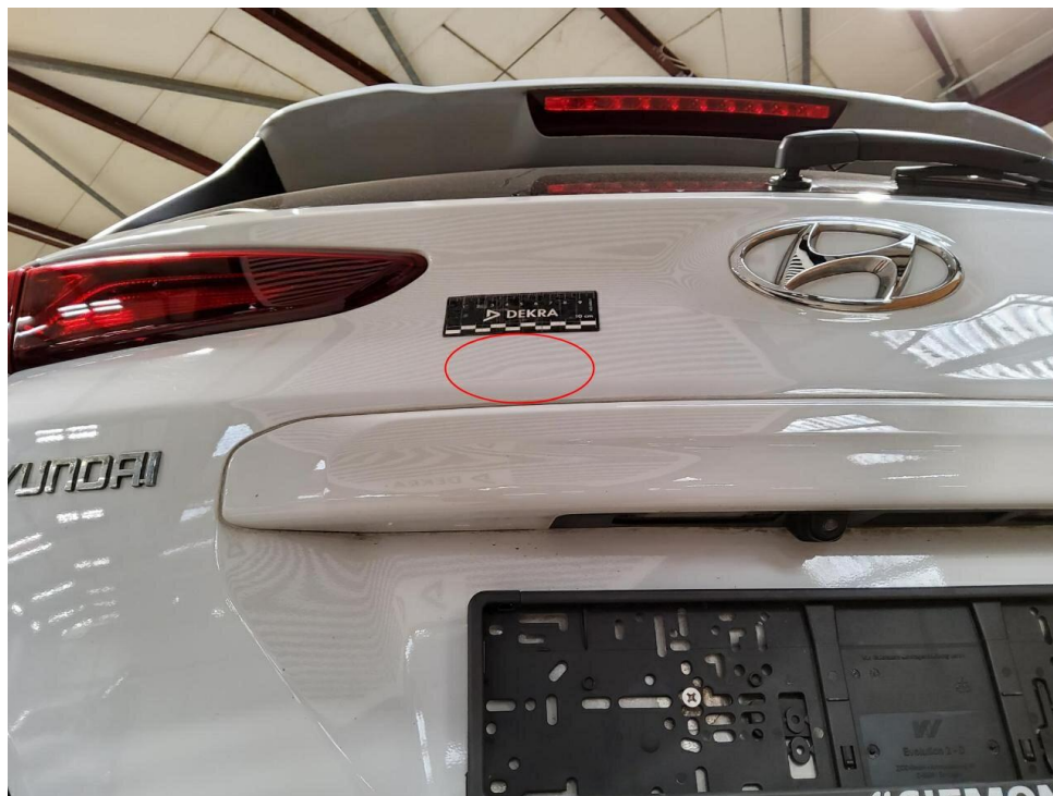
Bild 6 : Heckklappe, eingedellt, smart repair
