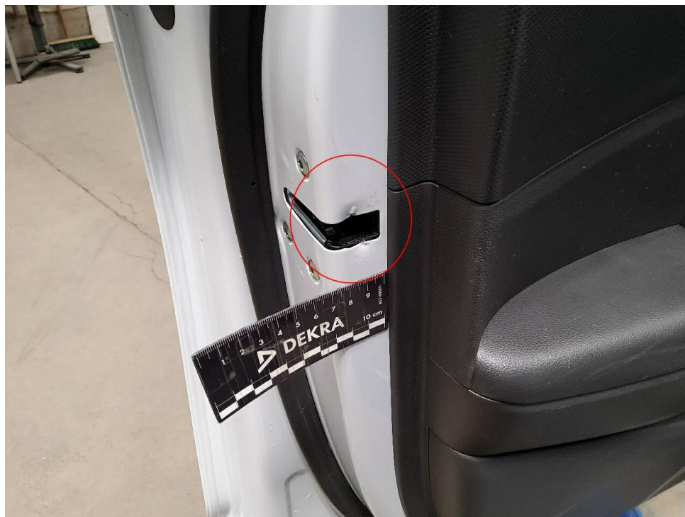
Bild 9 : Tür vorne links Innenfläche, eingedellt und Lackabplatzer
