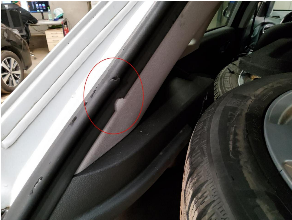
Bild 11 : Heckklappe Dichtung, beschädigt
