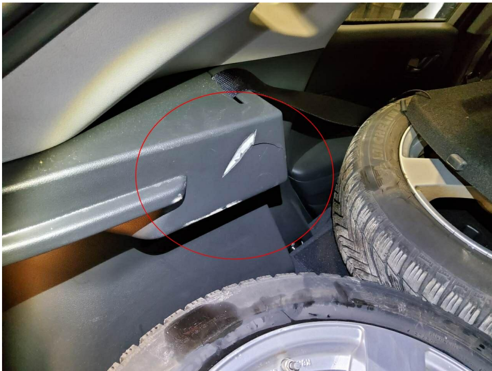
Bild 12 : Verkleidung Laderaum links, gebrochen
