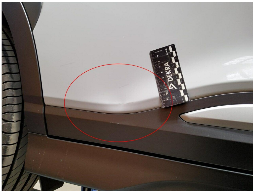
Bild 8 : Tür hinten rechts, zerkratzt und verformt , instandsetzen und lackieren mit Lackaufbau
