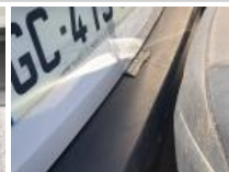
Pare-chocs AR, Déformé / Forcé, E - Remplacer
