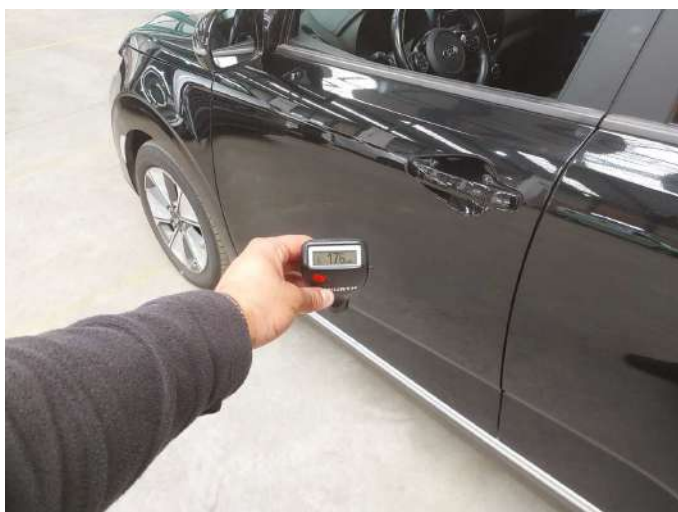
Door - front left side: 176 \mu\text{m}
