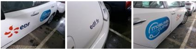
Carrosserie, Résidu de colle, Petit délettrage
