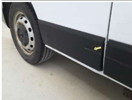
Ornament aripă / Spate dreapta / Zgâriat
