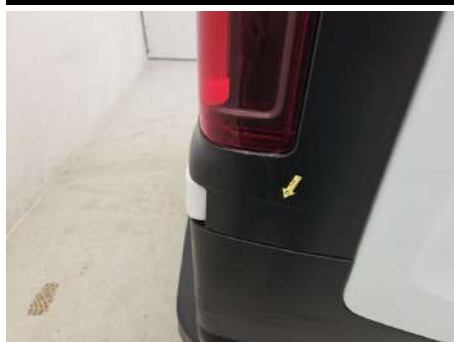
Ornament aripă / Spate dreapta / Zgâriat
