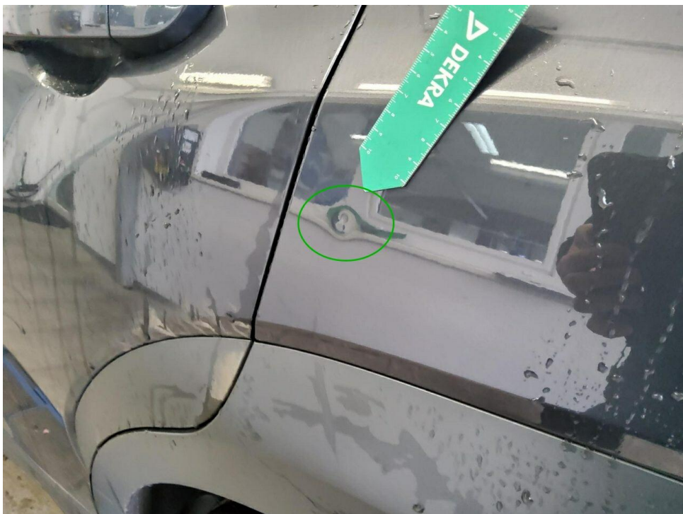
Bild 8 : Seitenteil hinten links, eingedellt, instandsetzen und lackieren mit Lackaufbau
