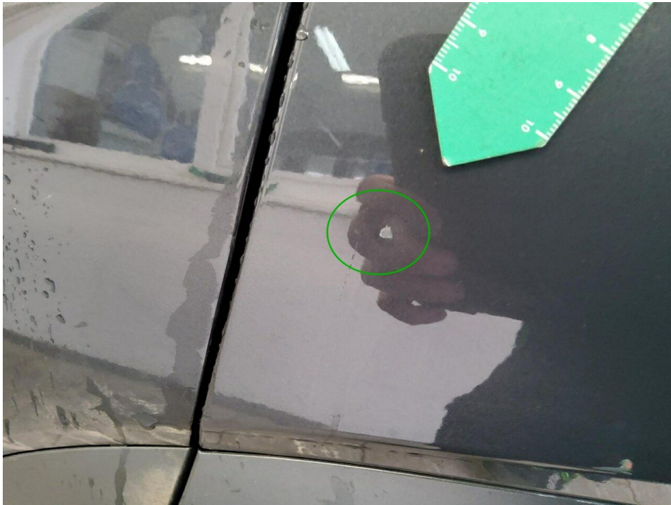
Bild 7 : Seitenteil hinten links, eingedellt, instandsetzen und lackieren mit Lackaufbau
