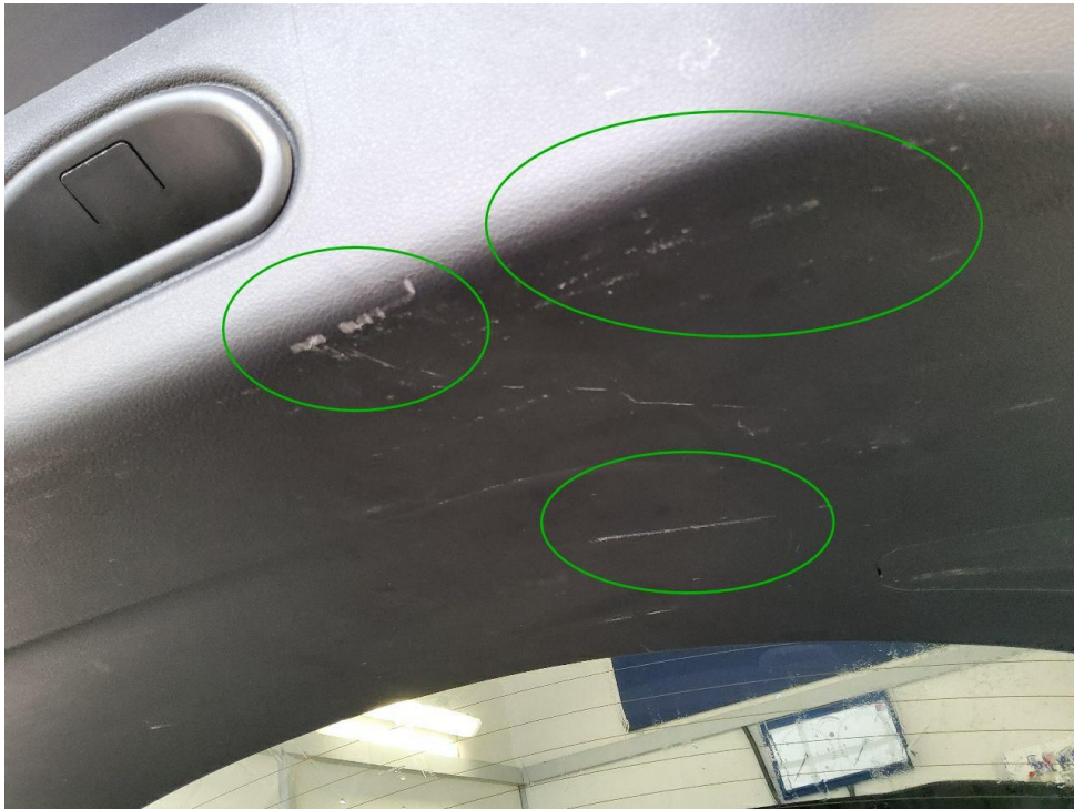
Bild 11 : Heckklappenverkleidung verschrammt, erneuern
