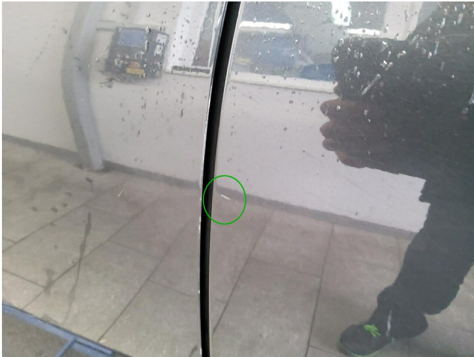
Bild 9 : Tür hinten links Lackierung, zerkratzt,
