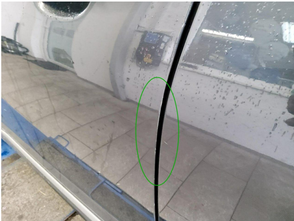
Bild 10 : Tür vorne links Lackierung, zerkratzt, smart repair
