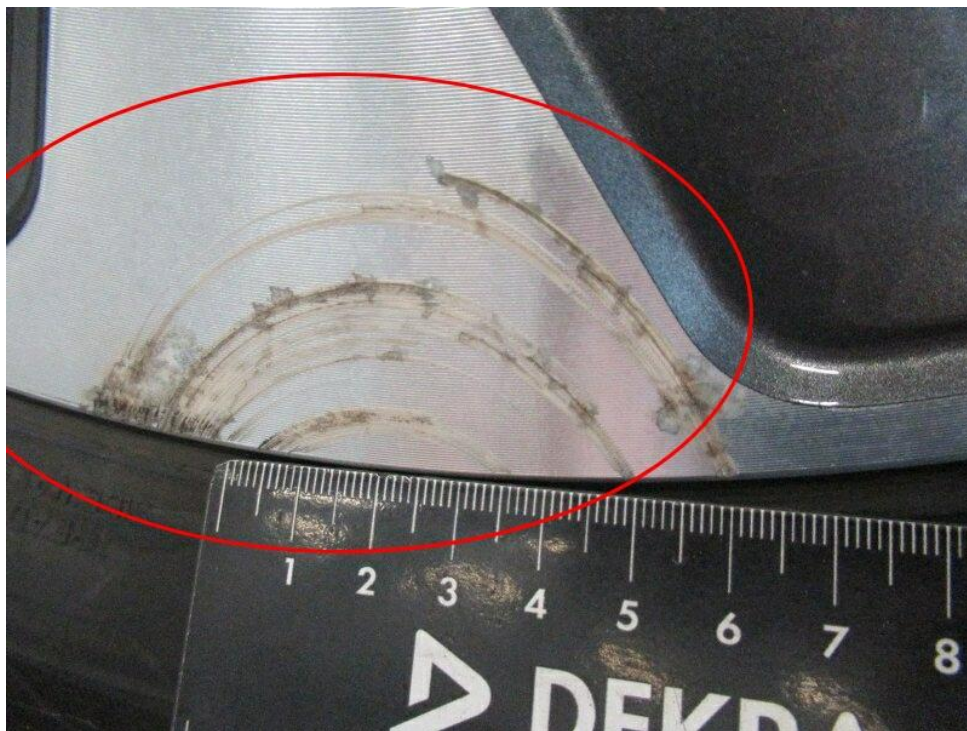
Bild 14 : Felge vorn rechts verschrammt mit Materialabtrag, erneuern
