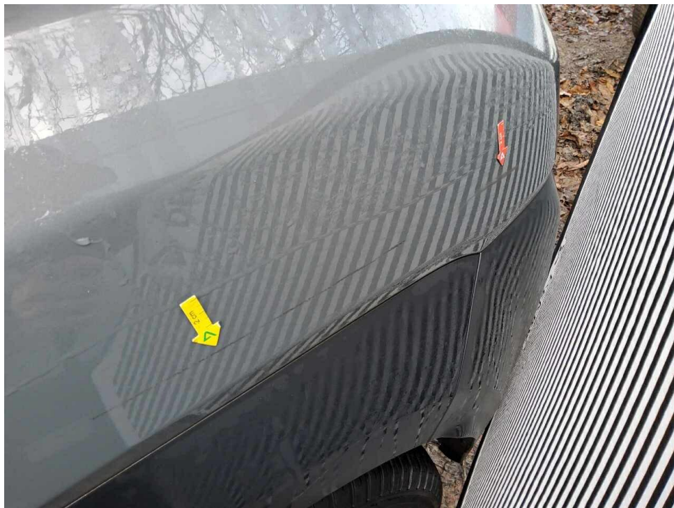
Bild 6 : Seitenteil hinten links, eingedellt,
