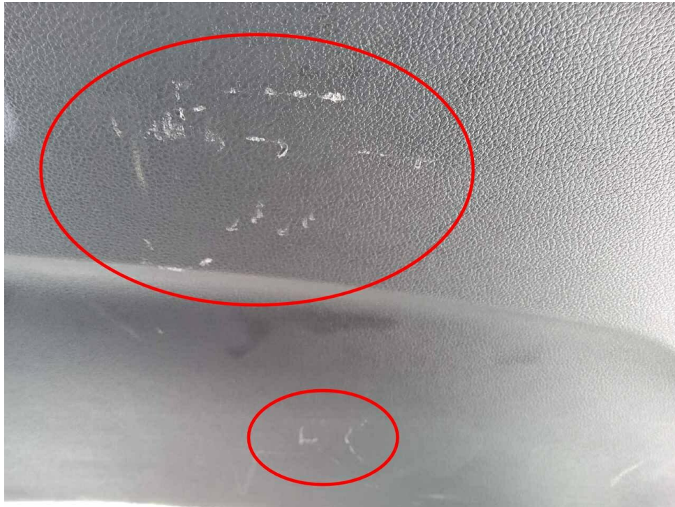
Bild 11 : Verkleidung Heckklappe verschrammt und gebrochen
