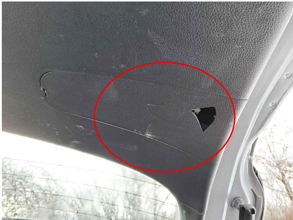
Bild 12 : Verkleidung Heckklappe verschrammt und gebrochen
