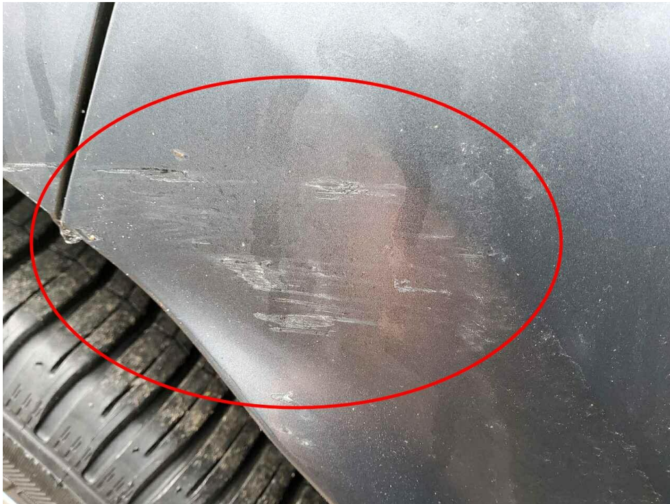
Bild 9 : Verkleidung Stoßfänger hinten mehrfach verschrammt
