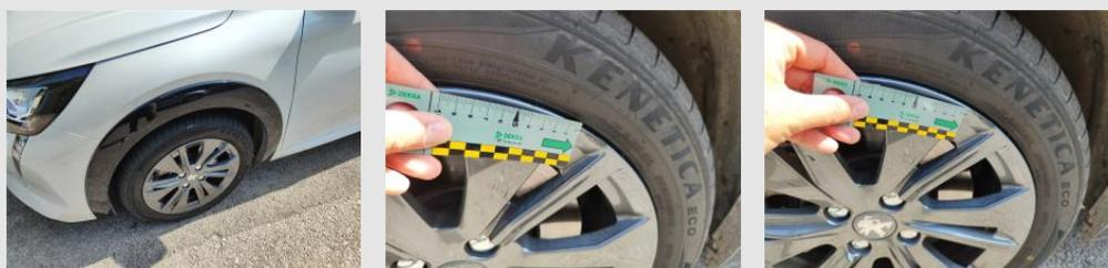
Componente: Disco ruota anteriore dx danneggiato Lato:
