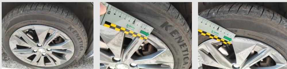
Componente: Disco ruota posteriore sx danneggiato
