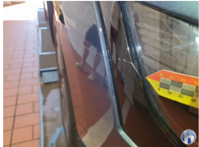
4. Zierleiste Beschädigt - Erneuern
