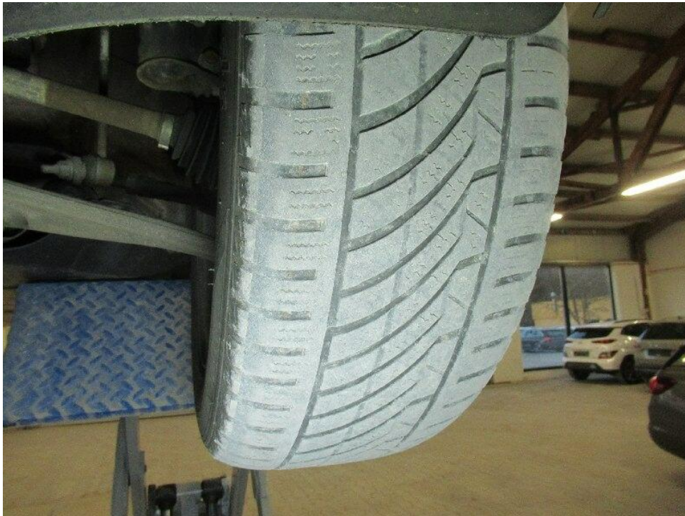
Bild 15 : Allwetterreifen vorn einseitig abgefahren, Fahrzeug vermessen
