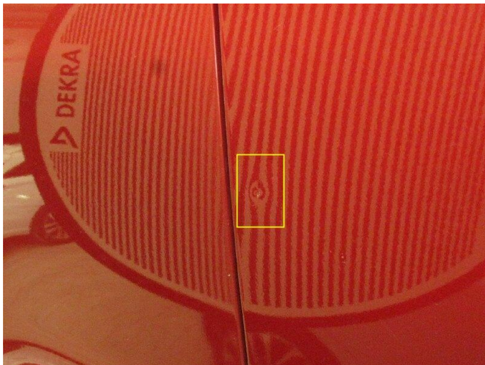
Bild 10 : Tür vorne rechts, mehrfach eingedellt, instandsetzen und lackieren mit Lackaufbau
