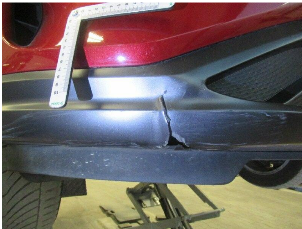
Bild 8 : Stoßfänger vorn Unterteil gebrochen, erneuern
