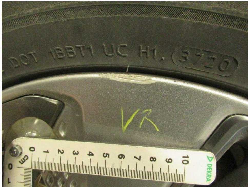
Bild 11 : Felge vorne rechts, zerkratzt, smart repair
