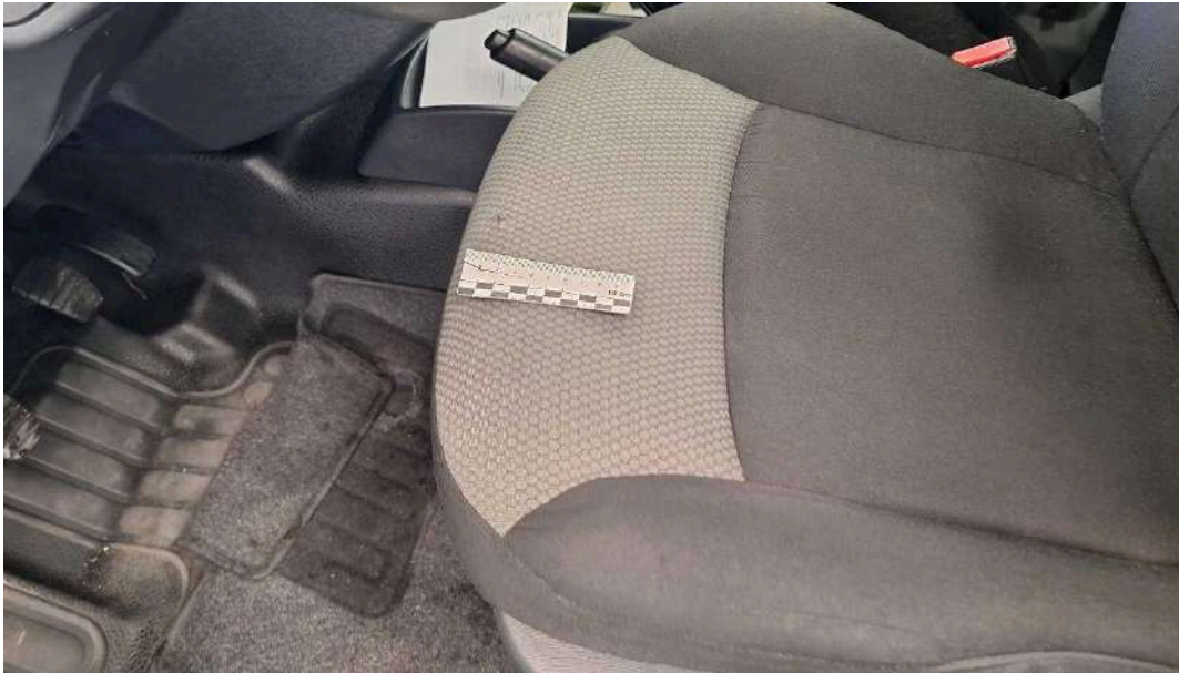
Bild 19 Innenraum Sitz vorne links Brandloch / Brandlöcher nicht reparabel
