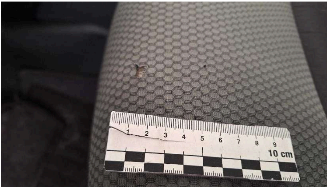
Bild 20 Innenraum Sitz vorne links Brandloch / Brandlöcher nicht reparabel
