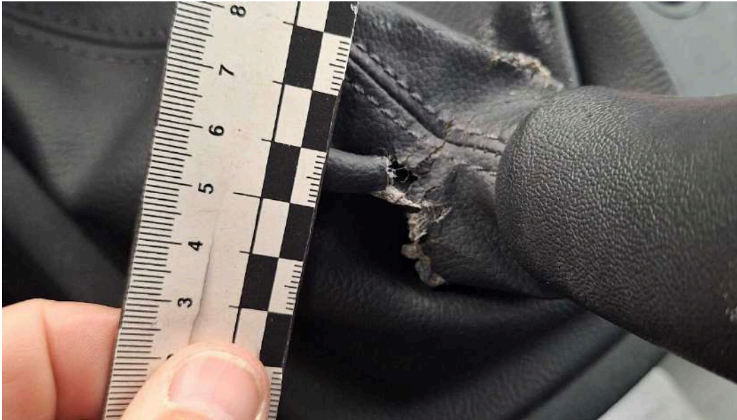
Bild 33 Innenraum Schaltmanschette gerissen / eingerissen
