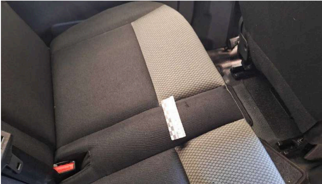
Bild 17 Innenraum Rücksitzbank gerissen / eingerissen
