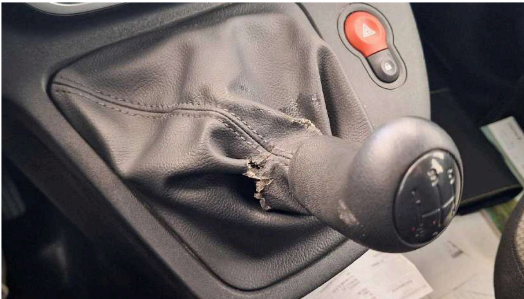
Bild 32 Innenraum Schaltmanschette gerissen / eingerissen
