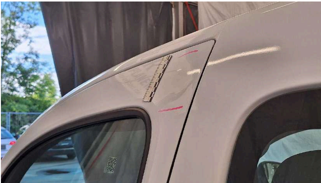
Bild 30 linke Seite Tür vorne links Delle
