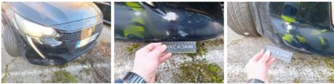
Pare-chocs AV, Déformé / Forcé, Le - Remplacer et peindre
