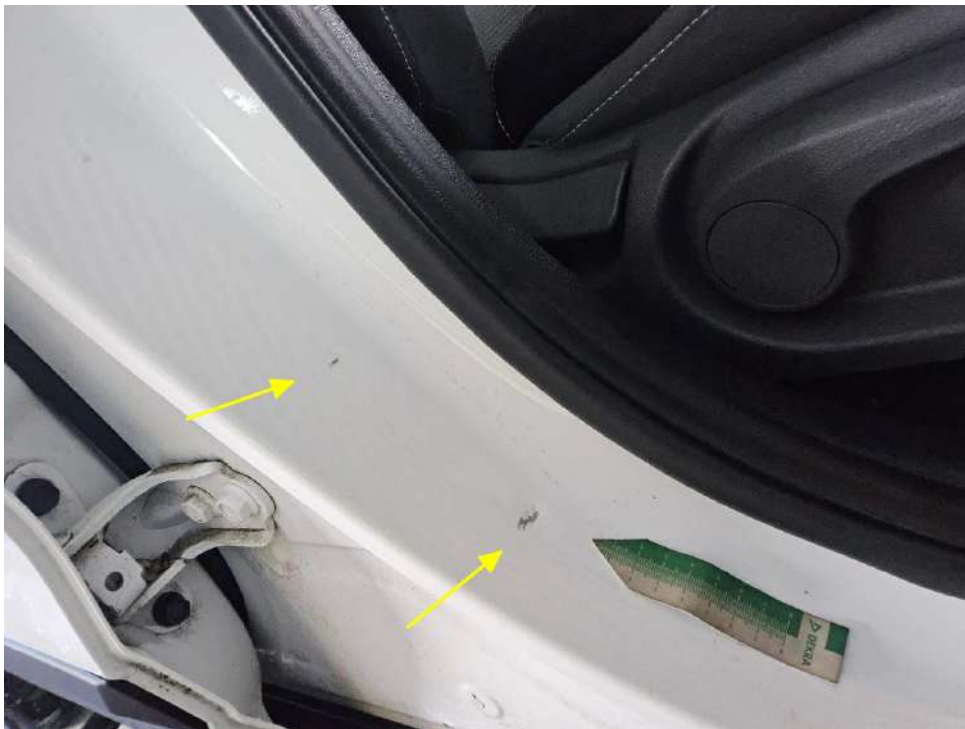
Bild 30 : Tür vorne rechts Einstieg, mehrfach eingedellt, smart repair
