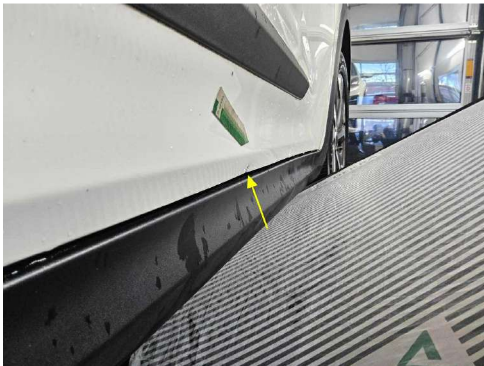
Bild 28 : Tür vorne rechts, verformt, instandsetzen und lackieren mit Lackaufbau
