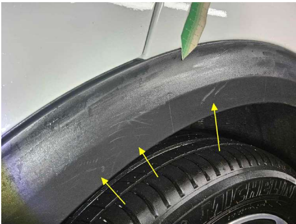
Bild 20 : Radlaufblende hinten links, zerkratzt
