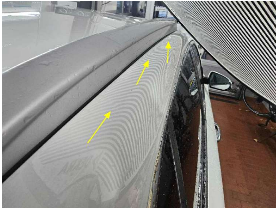
Bild 15 : Hagelschaden (Dach, Dachrahmen rechts, Motorhaube)
