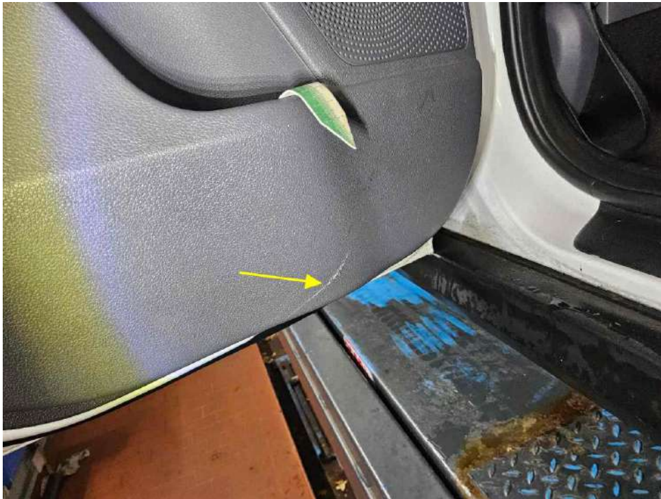
Bild 33 : Verkleidung Tür hinten links, zerkratzt, smart repair
