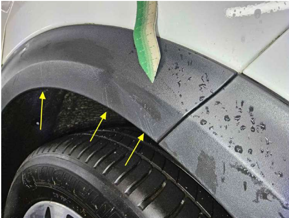
Bild 21 : Radlaufblende hinten links, zerkratzt
