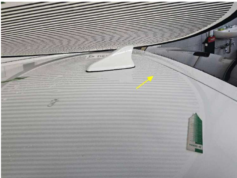
Bild 8 : Hagelschaden (Dach, Dachrahmen rechts, Motorhaube)
