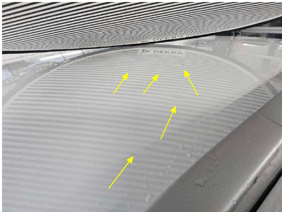
Bild 10 : Hagelschaden (Dach, Dachrahmen rechts, Motorhaube)
