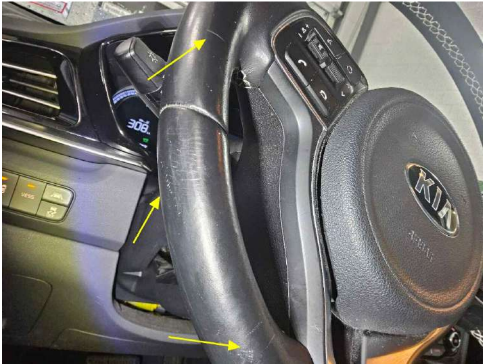
Bild 31 : Lenkrad, zerkratzt, smart repair
