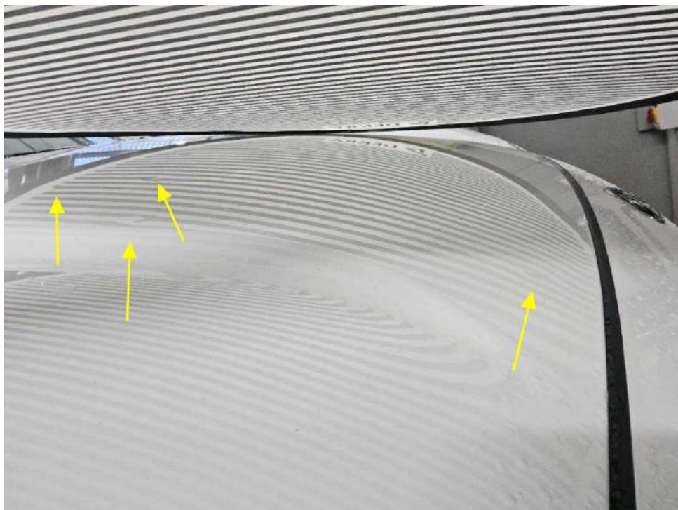
Bild 18 : Hagelschaden (Dach, Dachrahmen rechts, Motorhaube)
