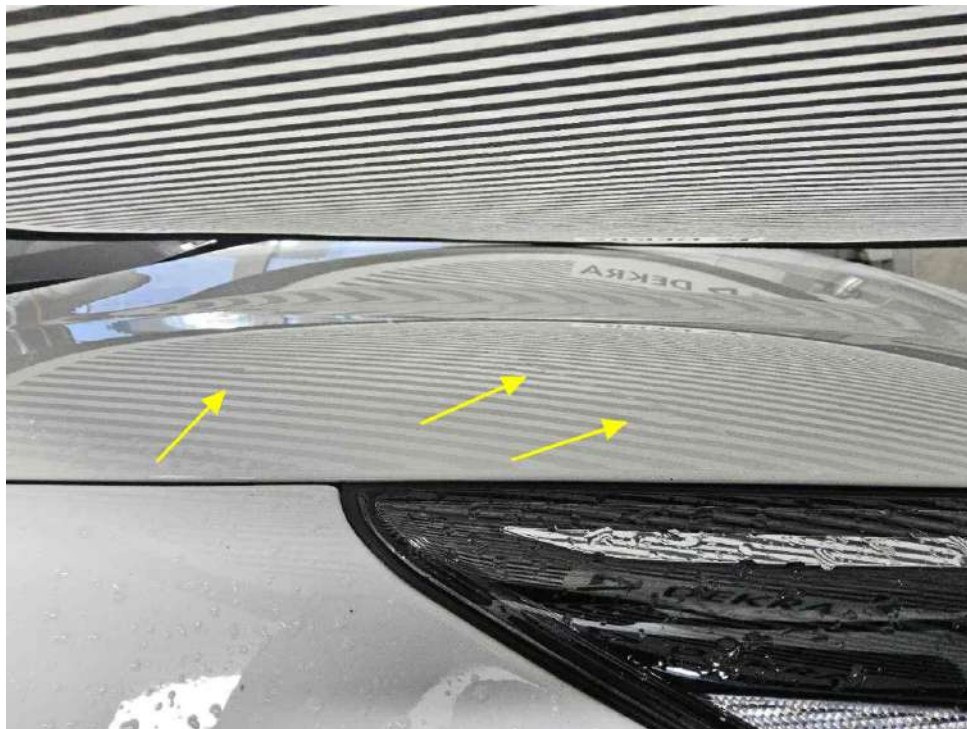
Bild 16 : Hagelschaden (Dach, Dachrahmen rechts, Motorhaube)
