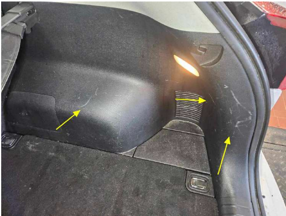
Bild 34 : Verkleidung Kofferraum rechts, zerkratzt, smart repair
