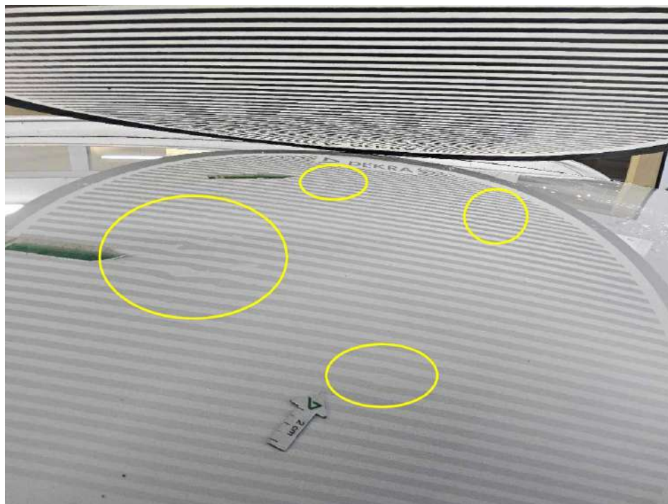
Bild 9 : Hagelschaden (Dach, Dachrahmen rechts, Motorhaube)
