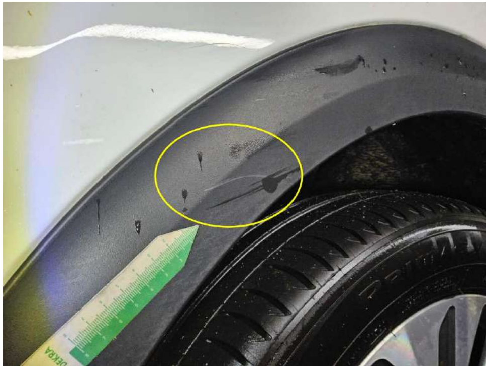
Bild 27 : Radlaufblende vorne rechts, zerkratzt
