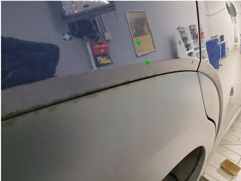
Bild 15 : Seitenwand hinten rechts Delle
