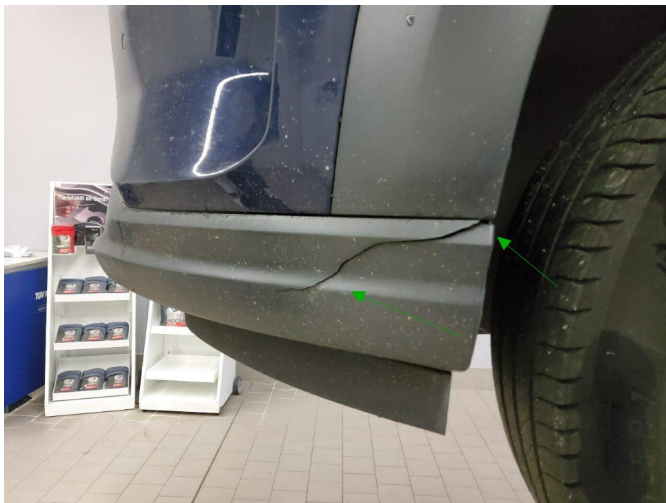
Bild 17 : Spoiler Stoßfänger vorne gebrochen
