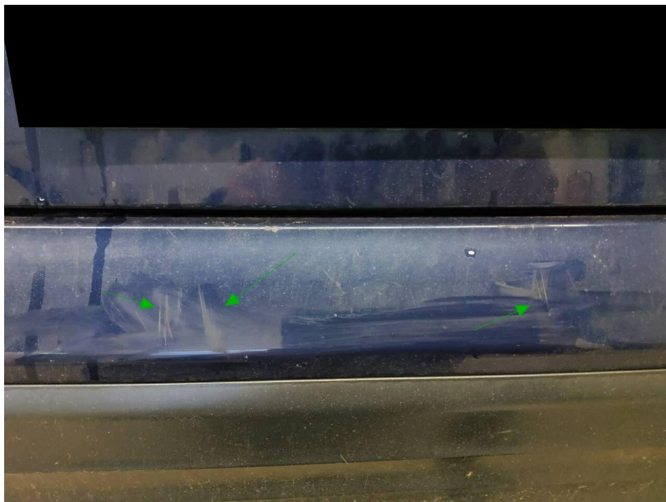
Bild 10 : Stoßfänger hinten Ladekante verschrammt
