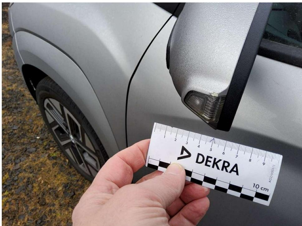
Bild 10 : Außenspiegelkappe und Blinker zerkratzt
