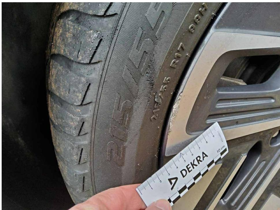
Bild 6 : Felge vorne links verschrammt
