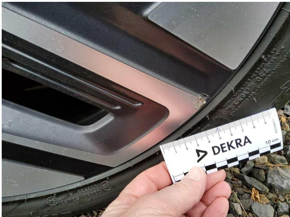
Bild 7 : Felge hinten links verschrammt
