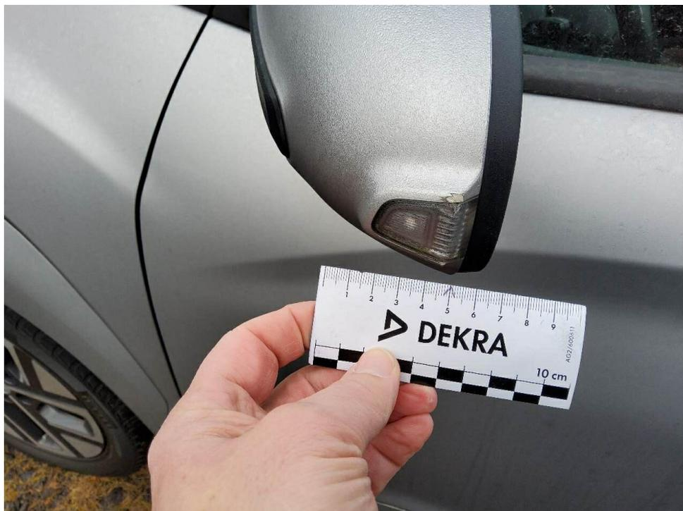
Bild 8 : Außenspiegelkappe und Blinker zerkratzt
