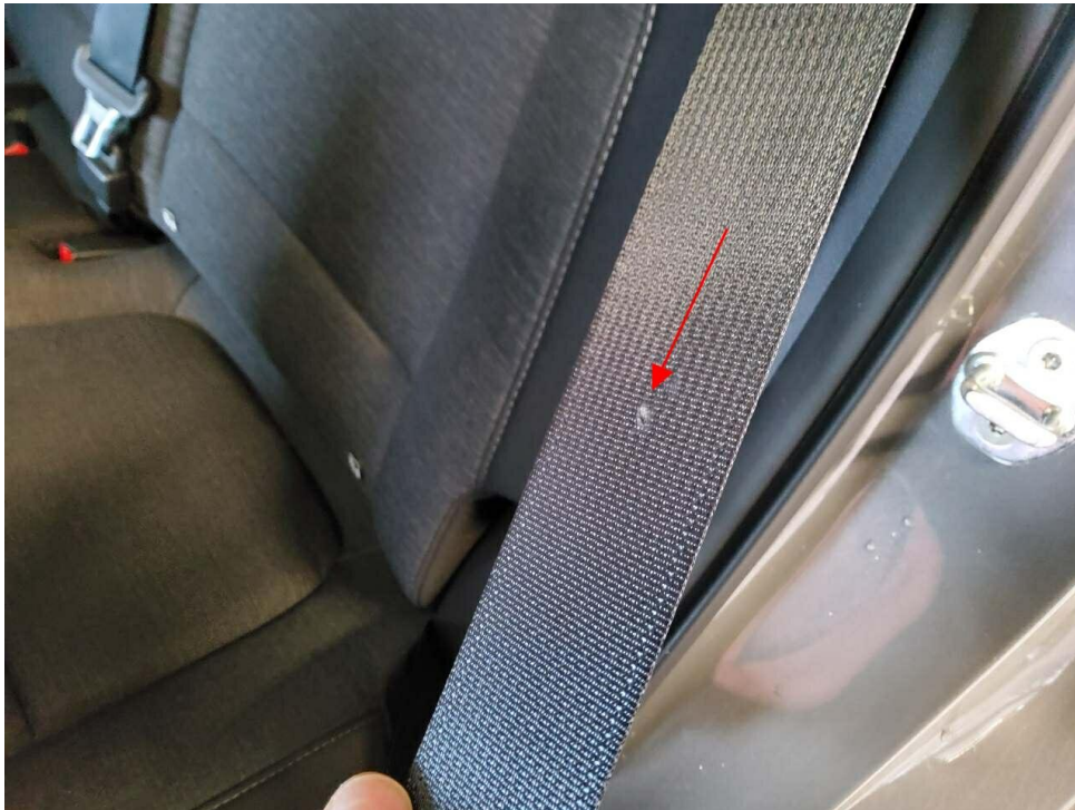
Bild 11 : Gurt hinten links beschädigt
