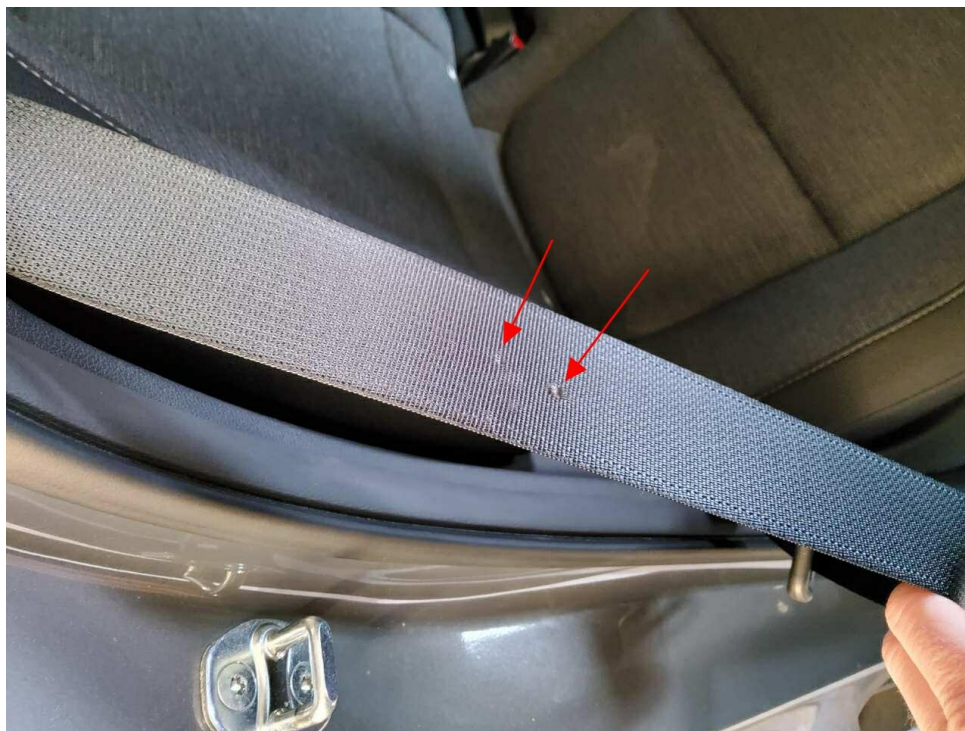
Bild 10 : Gurt hinten rechts beschädigt
