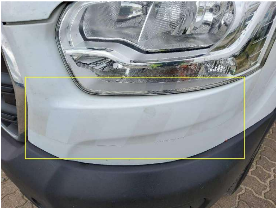
Bild 20 : Lack aufbereiten nach Entfernen der Beklebung
