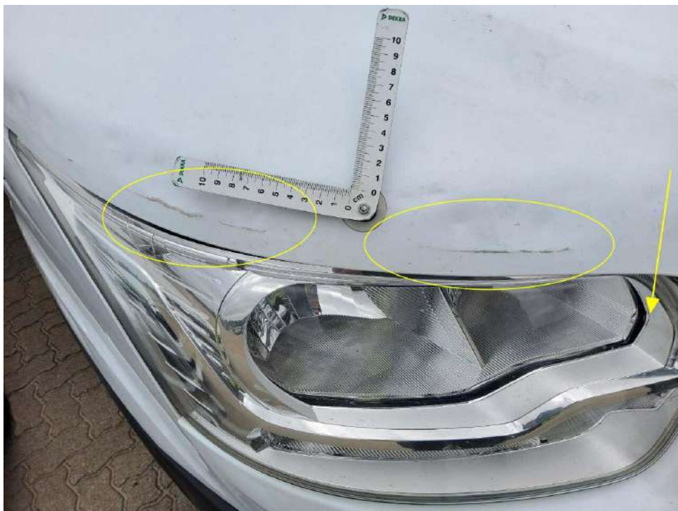
Bild 14 : Motorhaube Lackierung, verschrammt, bereits durch Hagel geschädigt Scheinwerfer rechts gem. Angabe Werkstatt gebrochen
