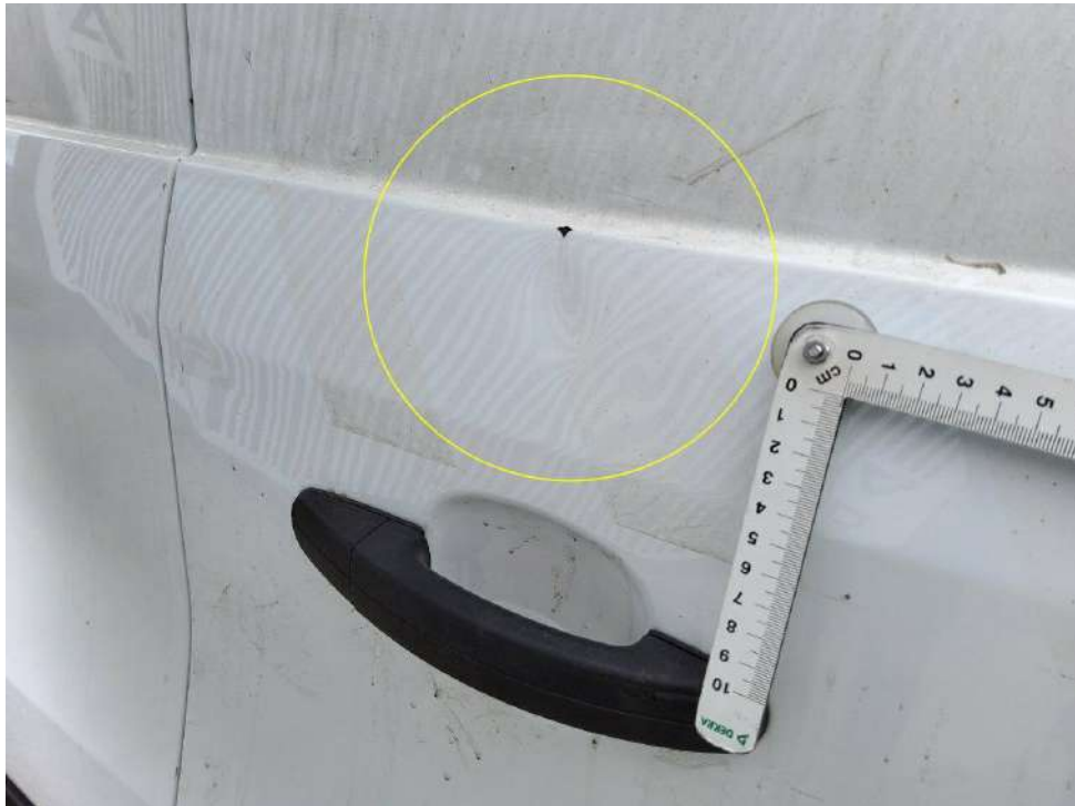
Bild 11 : Hecktüre rechts, deformiert, instandsetzen und lackieren mit Lackaufbau
