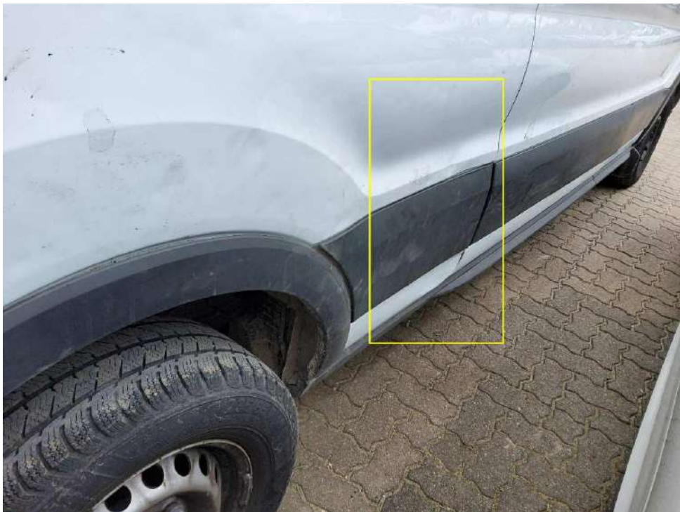
Bild 40 : Seitenwand rechts deformiert. bereits durch Hagel geschädigt
