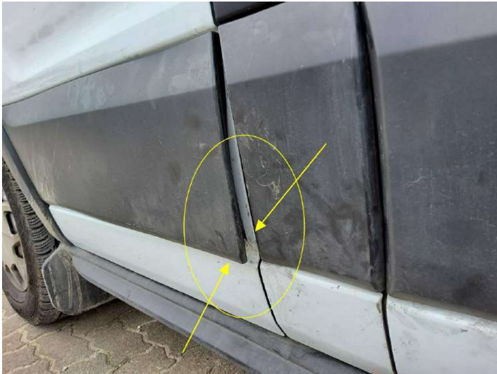
Bild 49 : Rammschutzleiste Tür vorn links lose
