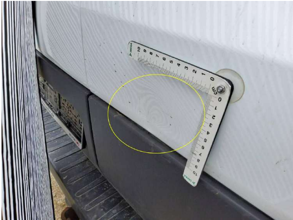
Bild 13 : Hecktüre rechts, deformiert, instandsetzen und lackieren mit Lackaufbau
