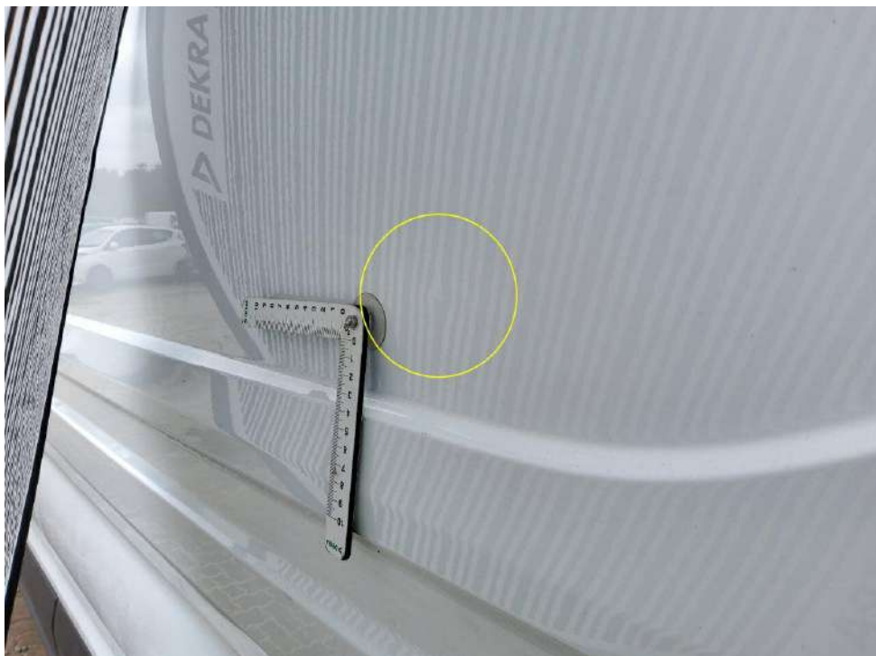
Bild 10 : Seitenwand (lang) hinten links, hinten, eingedellt, Gebrauchsspur
