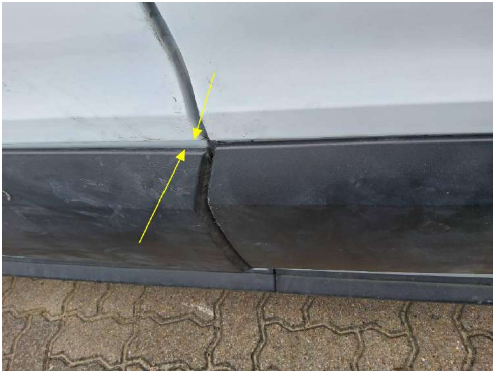
Bild 39 : Rammschutzleisten rechts lose
