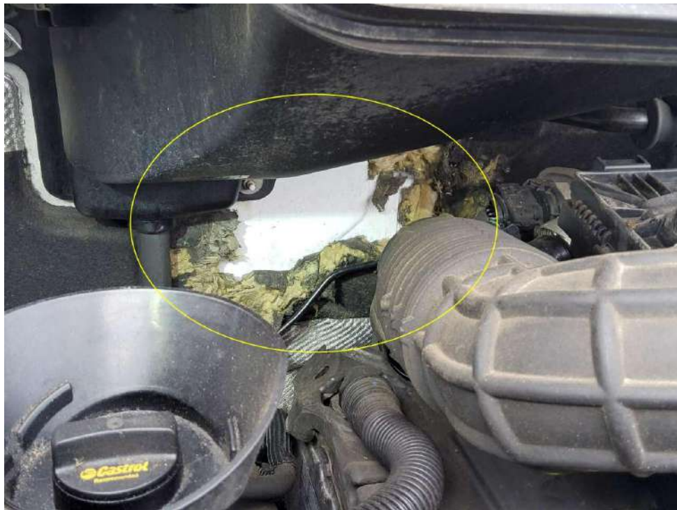
Bild 48 : Dämmung Motorraum beschädigt
