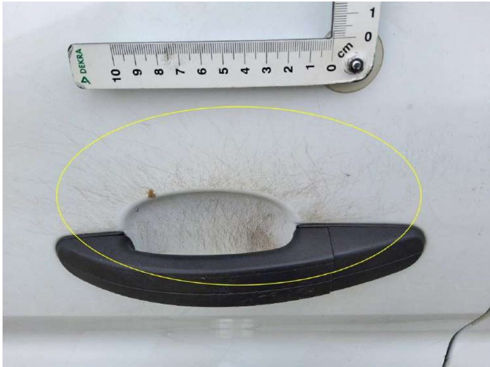
Bild 9 : Tür vorne links Lackierung, oberflächliche Kratzer , Gebrauchsspur
