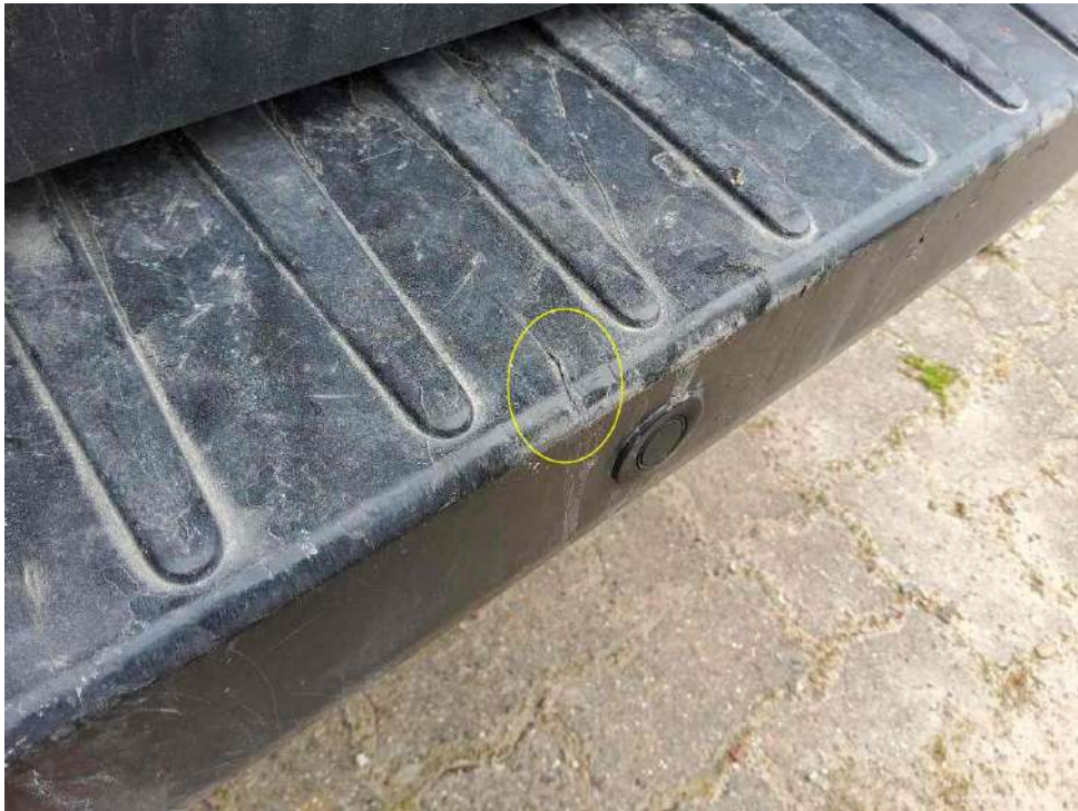
Bild 43 : Stoßfänger hinten verschrammt
