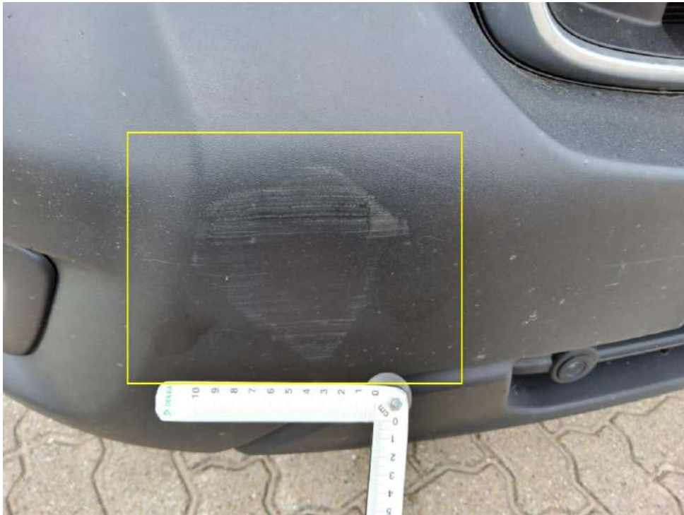
Bild 23 : Stoßfänger vorn zerkratzt
