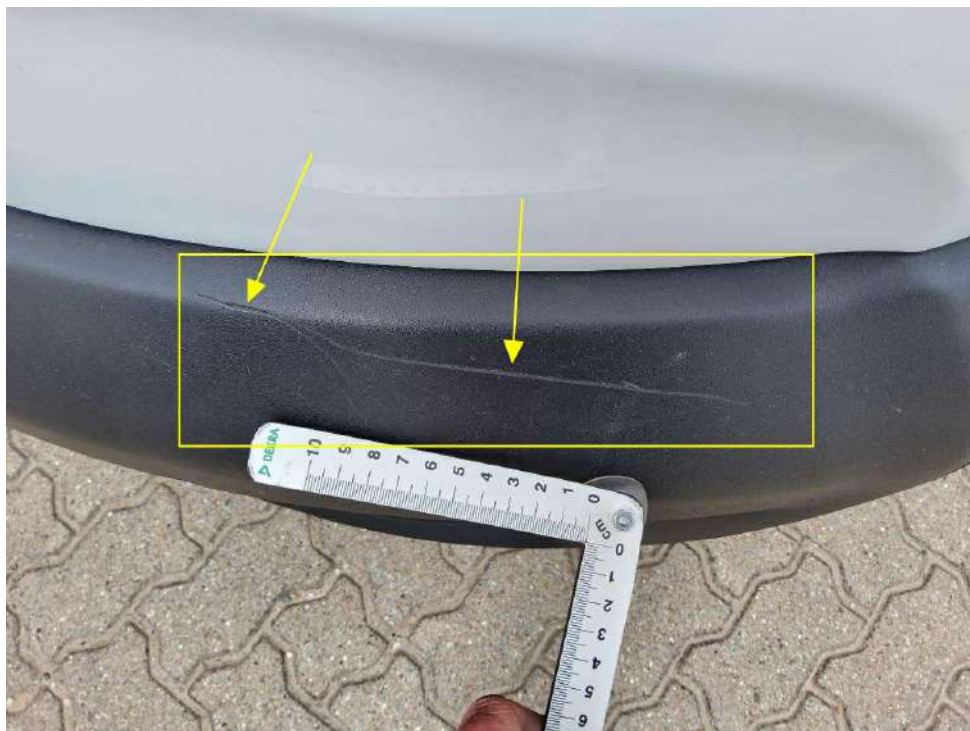
Bild 22 : Stoßfänger vorn zerkratzt
