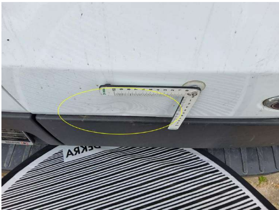
Bild 12 : Hecktüre rechts, deformiert, instandsetzen und lackieren mit Lackaufbau
