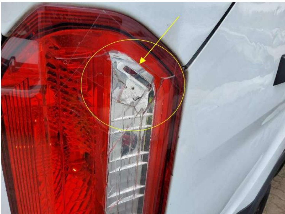
Bild 42 : Rücklicht rechts gebrochen
