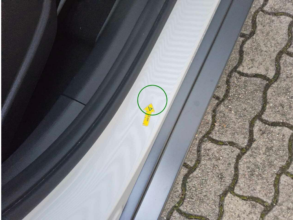
Bild 7 : Einstieg vorne rechts eingedellt
