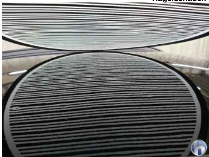
14. Dach ca 90 stk a 10mm
