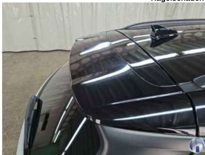
18. Heckklappe ca 10 stk a 10mm Hagelschaden
