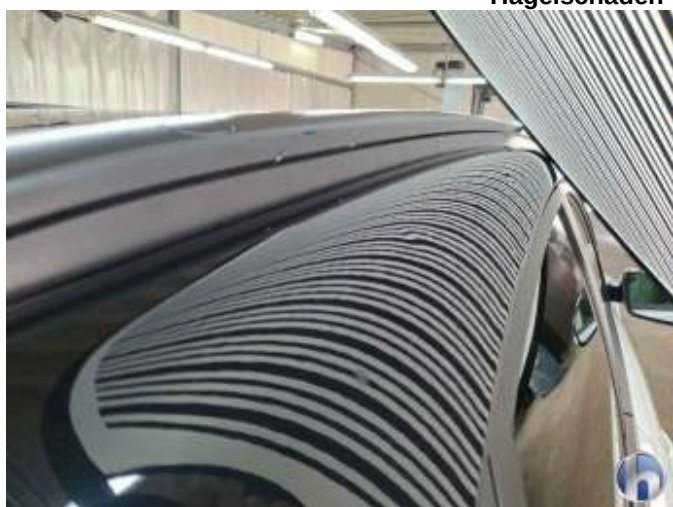
15. Dachrahmen - Rechts ca 15 stk a 10mm
