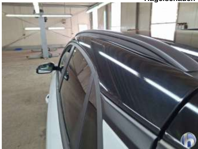
17. Dachrahmen - Links ca 5 stk a 10mm Hagelschaden
