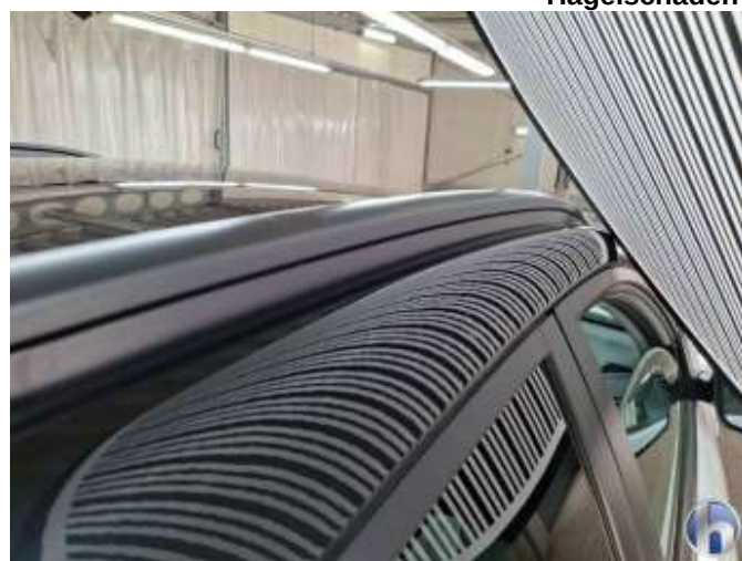
15. Dachrahmen - Rechts ca 15 stk a 10mm
