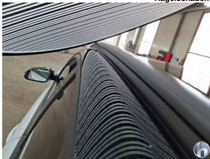
17. Dachrahmen - Links ca 5 stk a 10mm Hagelschaden
