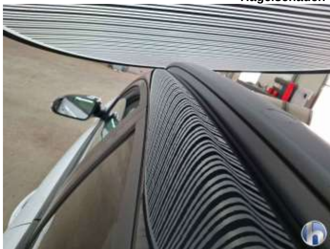
17. Dachrahmen - Links ca 5 stk a 10mm Hagelschaden
