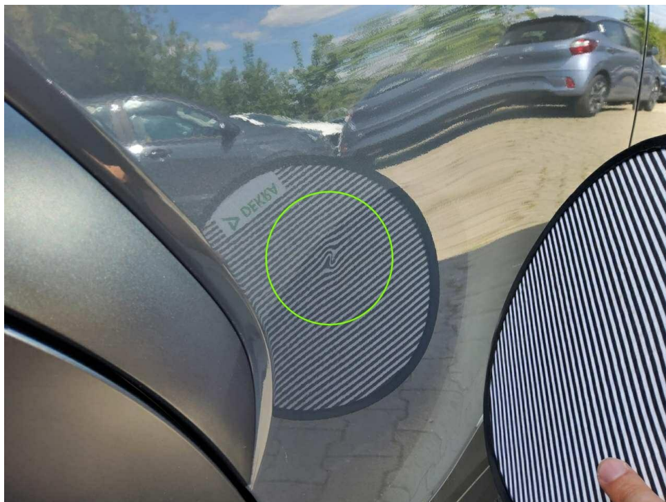
Bild 8 : Tür hinten rechts, eingedellt, drücken
