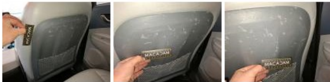
Garniture porte ARD, Griffe(s), E - Remplacer
