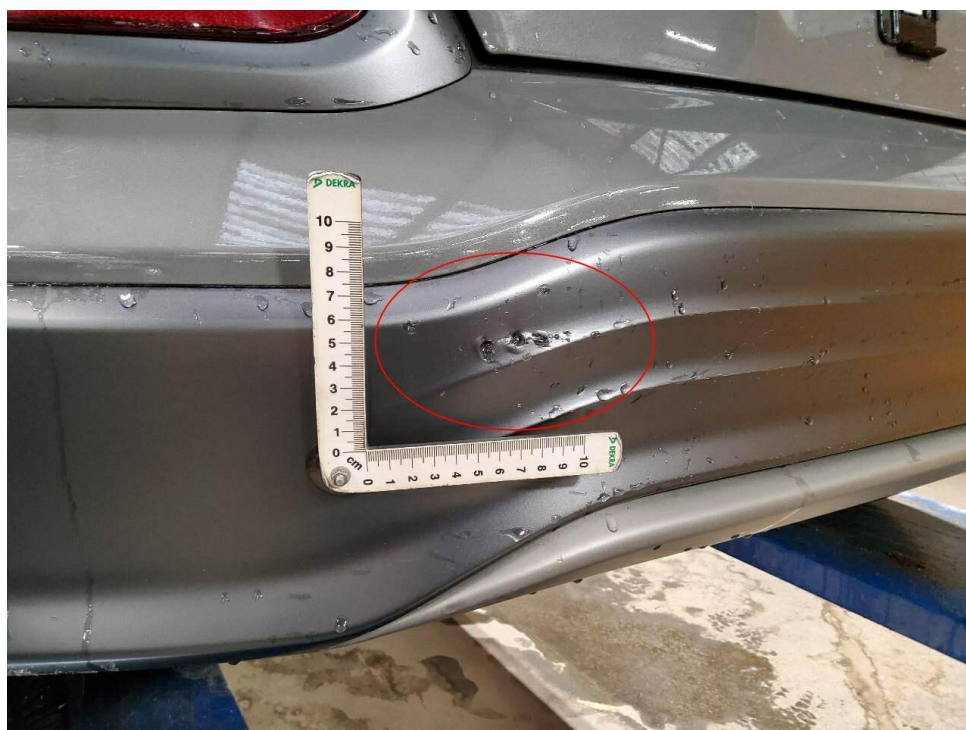
Bild 12 : Stoßfänger hinten, beschädigt
