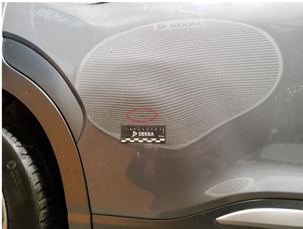
Bild 9 : Tür hinten rechts, eingedellt
