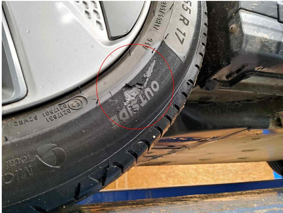
Bild 13 : Reifen vorne links, Flankenschaden
