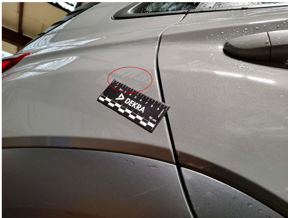
Bild 10 : Seitenteil rechts Lackierung, zerkratzt
