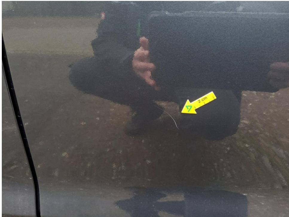
Bild 11 : Tür hinten links Lackierung, zerkratzt,
