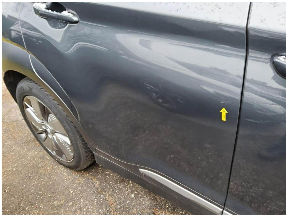
Bild 12 : Tür hinten rechts Lackierung, zerkratzt,
