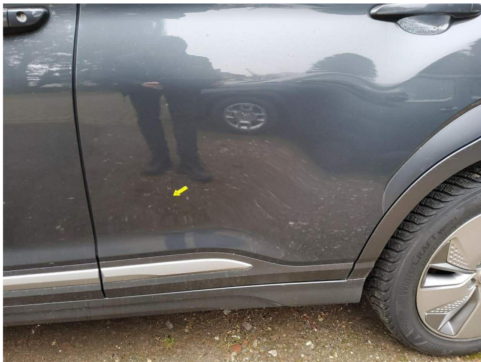
Bild 10 : Tür hinten links Lackierung, zerkratzt,
