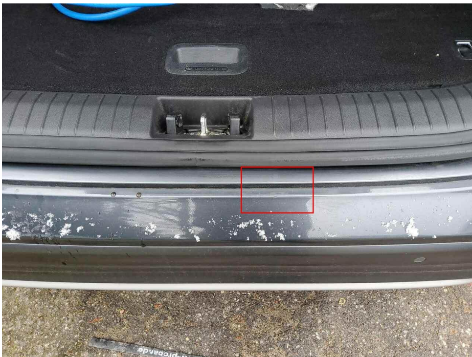
Bild 8 : Stoßfänger hinten Lackierung, verschrammt, smart repair
