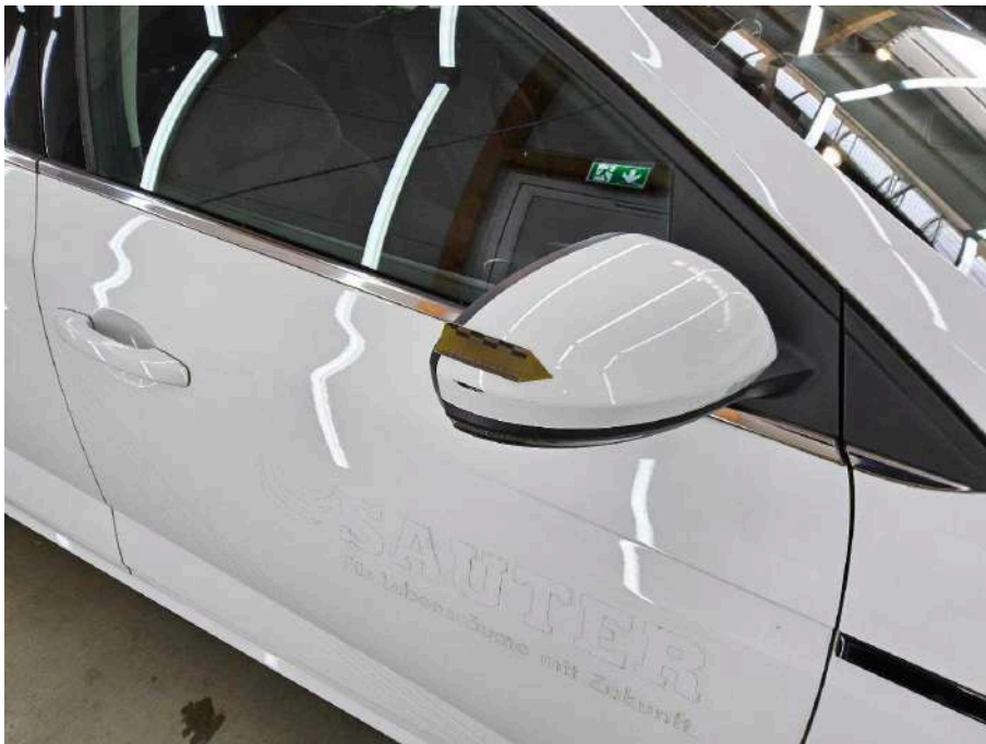
Bild 50 rechte Seite Abdeckung Außenspiegel rechts Materialabtrag
