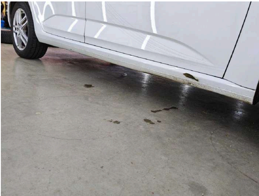
Bild 48 rechte Seite Schweller rechts deformiert
