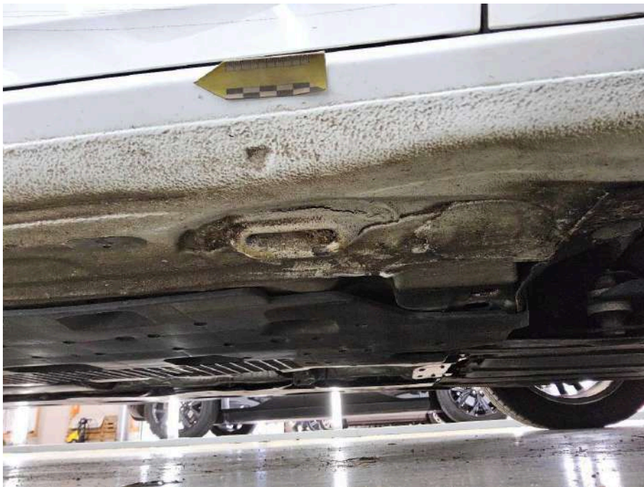
Bild 49 rechte Seite Schweller rechts deformiert
