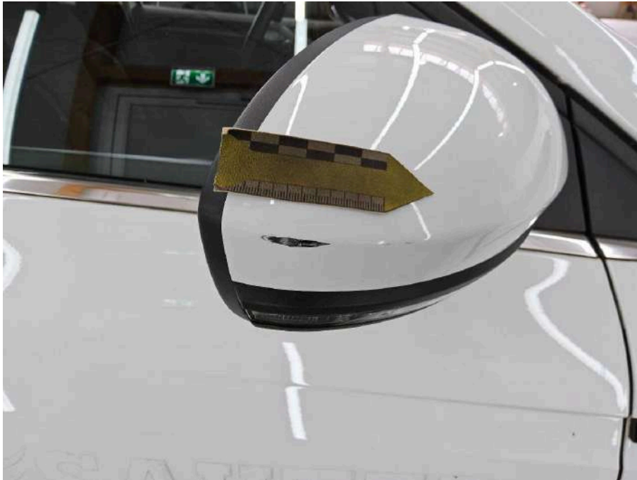
Bild 51 rechte Seite Abdeckung Außenspiegel rechts Materialabtrag
