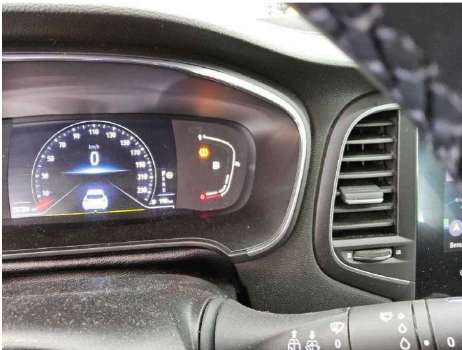
Bild 19 Systeme Reifendruckkontrollsystem aktiv / gestört
