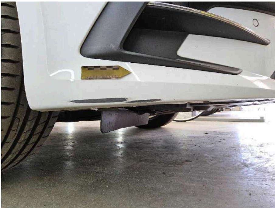
Bild 29 Fahrzeugfront Stoßfänger vorne verkratzt
