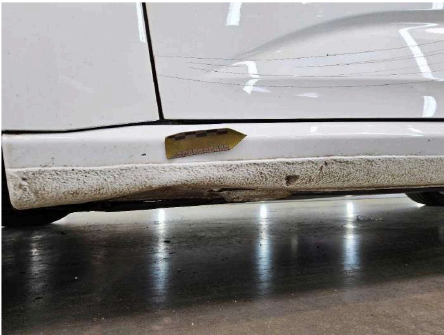
Bild 32 linke Seite Schweller links deformiert
