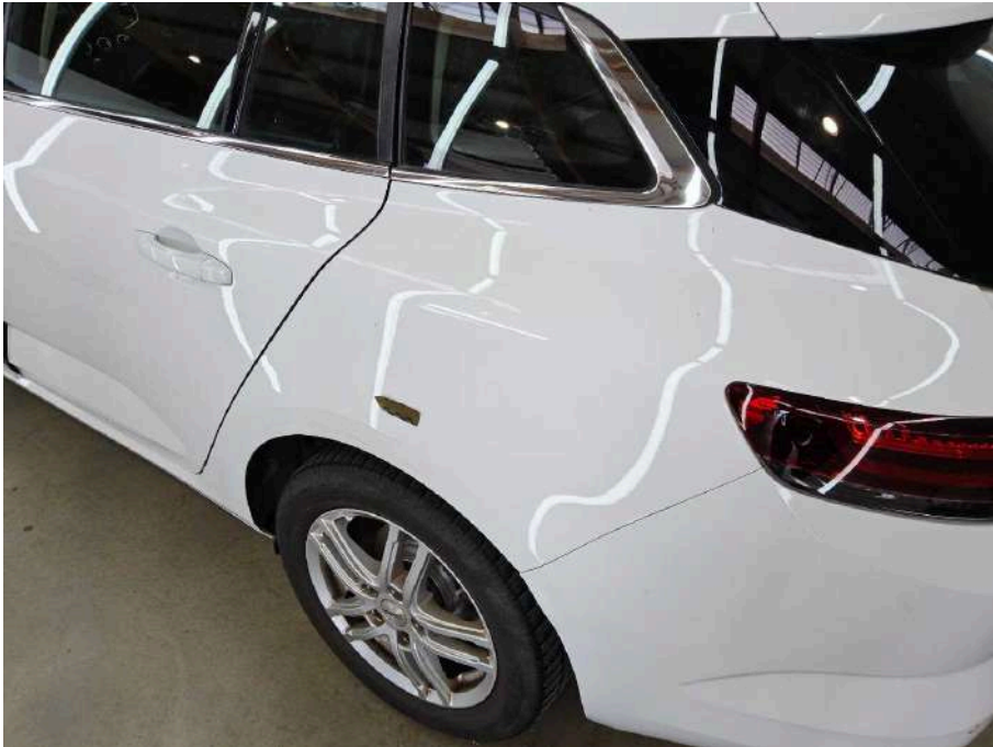
Bild 41 linke Seite Seitenteil hinten links deformiert
