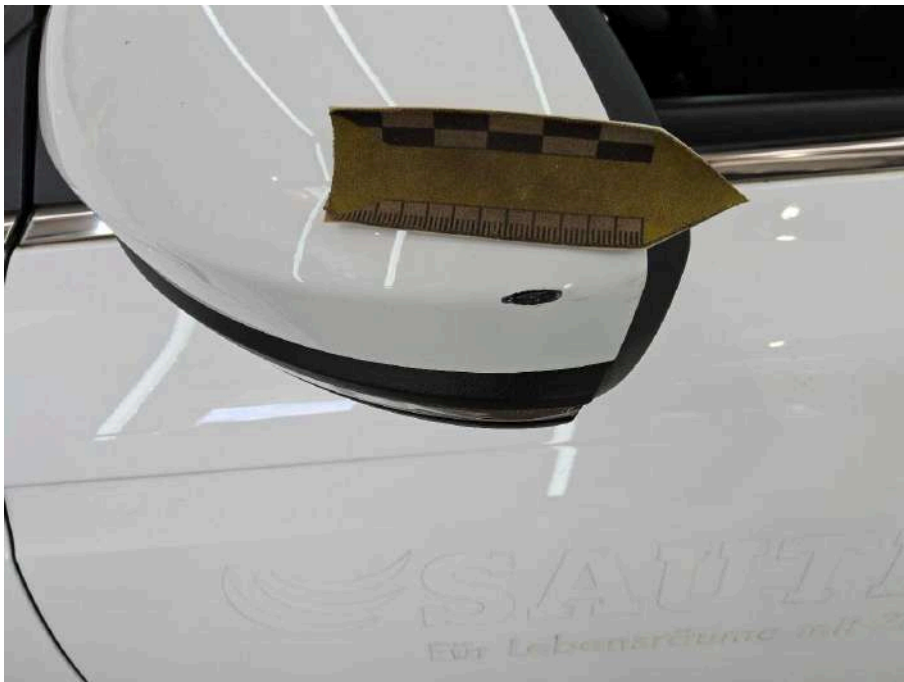
Bild 38 linke Seite Abdeckung Außenspiegel links Materialabtrag
