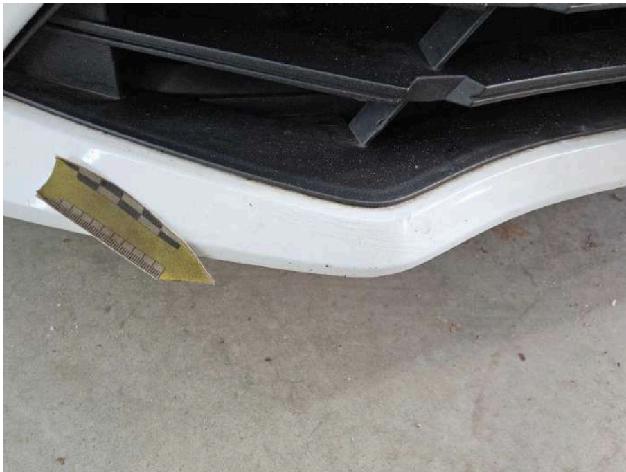
Bild 30 Fahrzeugfront Stoßfänger vorne verkratzt
