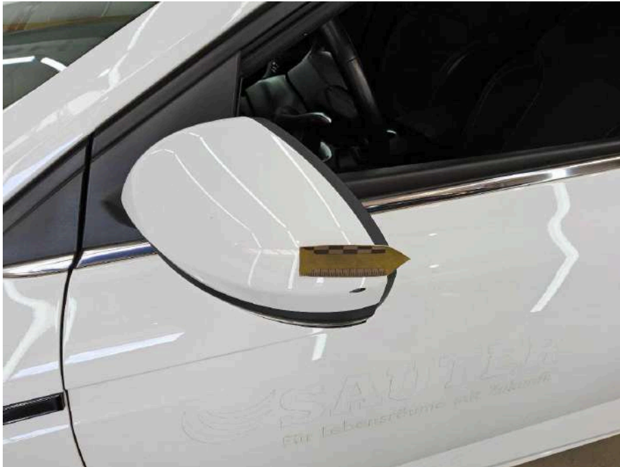
Bild 37 linke Seite Abdeckung Außenspiegel links Materialabtrag
