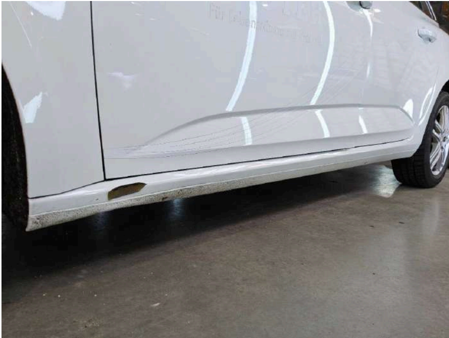
Bild 31 linke Seite Schweller links deformiert
