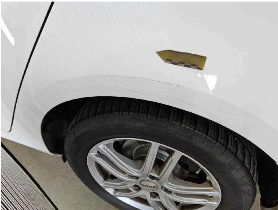
Bild 42 linke Seite Seitenteil hinten links deformiert
