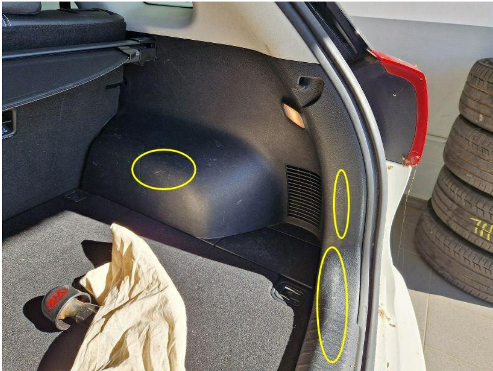
Bild 17 : Kofferraum - Laderaum verschrammt
