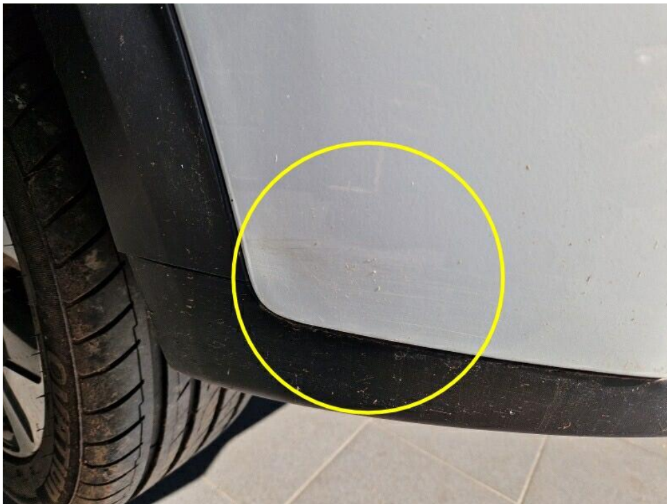
Bild 24 : Ladekante & linke Seitenfläche am Stoßfänger hinten zerkratzt
