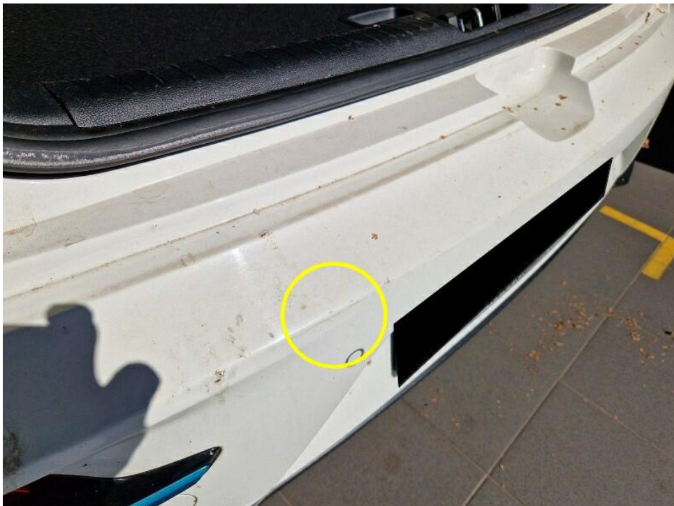
Bild 18 : Ladekante & linke Seitenfläche am Stoßfänger hinten zerkratzt
