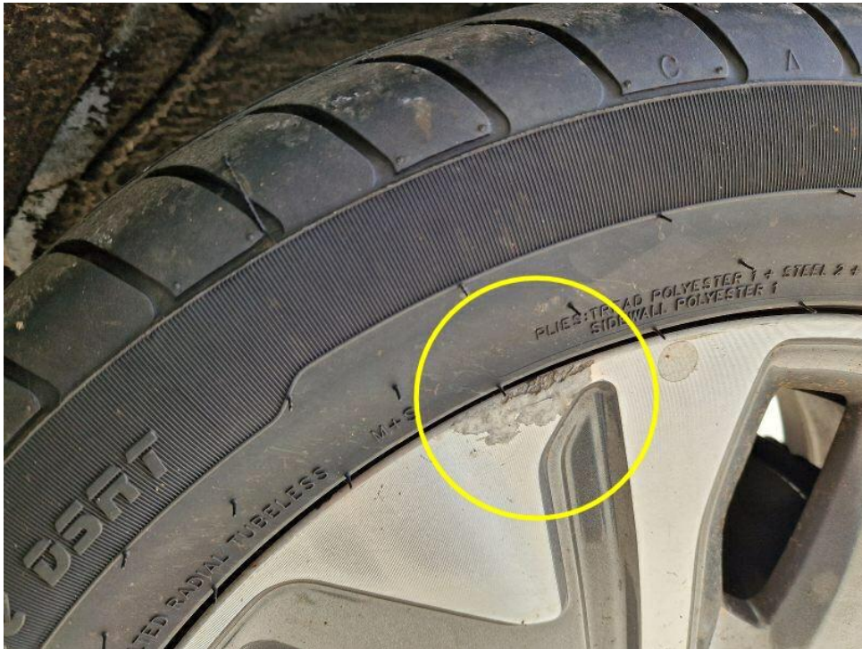
Bild 23 : LM-Rad(Glanzgedreht) hinten links verschrammt (Bordsteinschaden)
