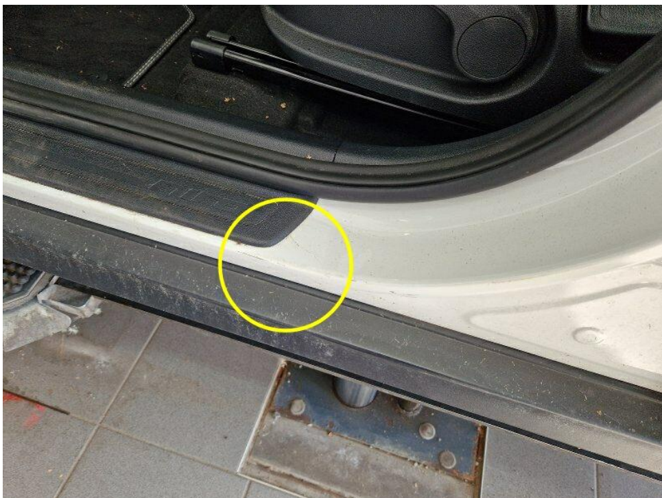
Bild 20 : Einstieg Fahrtür leicht verschrammt
