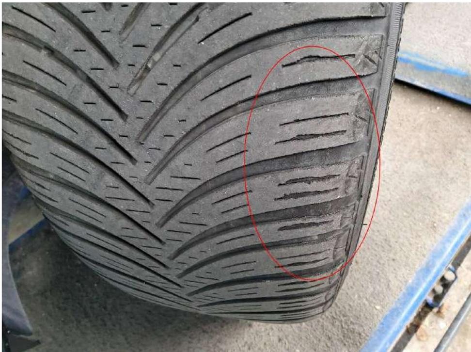
Bild 20 : Reifen vorne links, abgefahren
