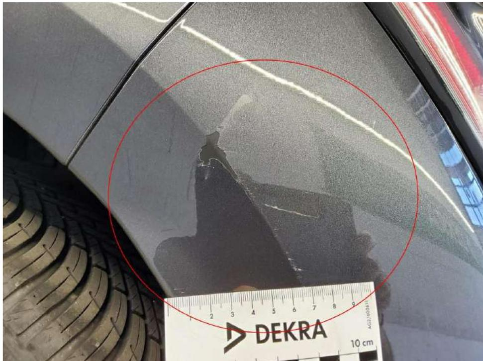
Bild 11 : Stoßfänger hinten Lackierung, verschrammt, lackieren mit Lackaufbau
