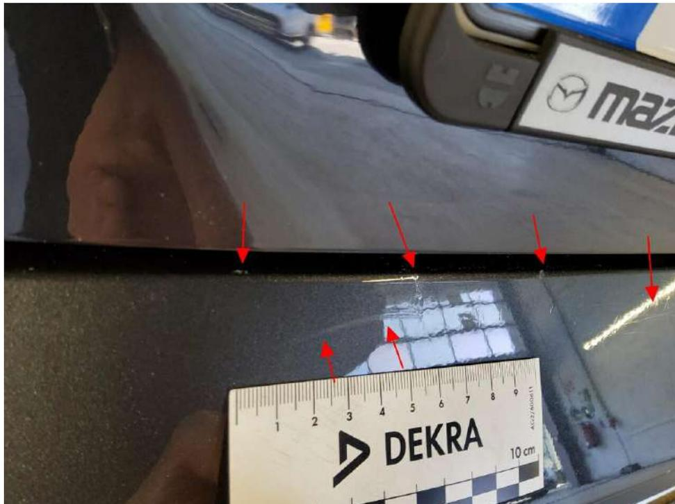
Bild 15 : Stoßfänger hinten Lackierung, verschrammt, lackieren mit Lackaufbau
