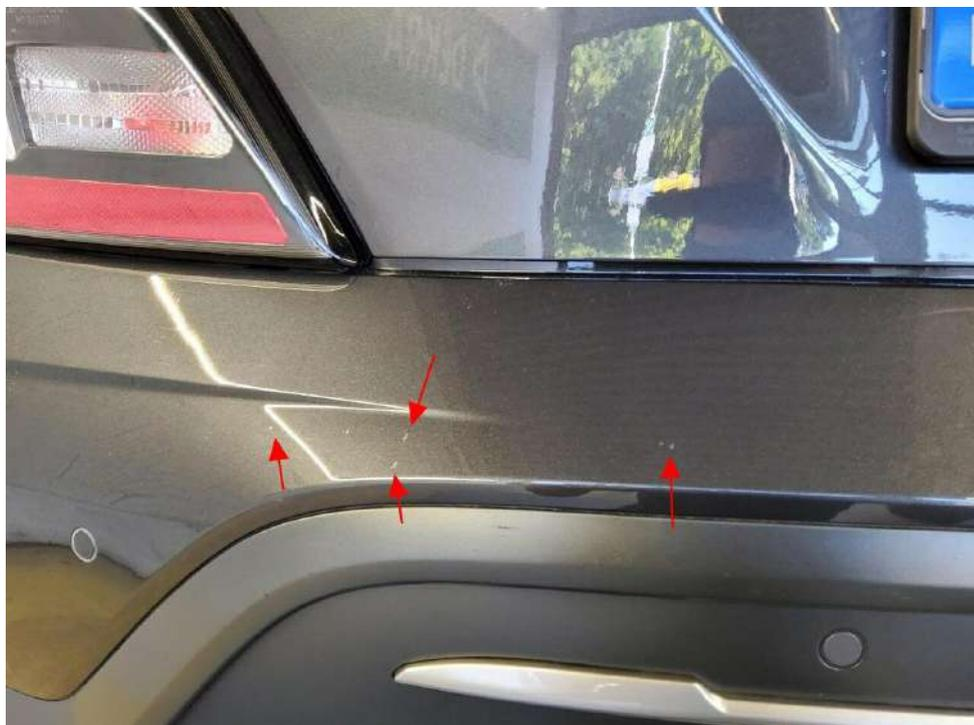
Bild 14 : Stoßfänger hinten Lackierung, verschrammt, lackieren mit Lackaufbau
