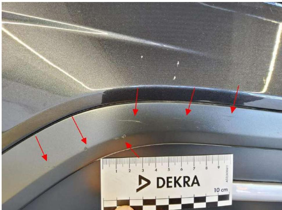
Bild 16 : Heckschürze hinten unten, zerkratzt, lackieren mit Lackaufbau
