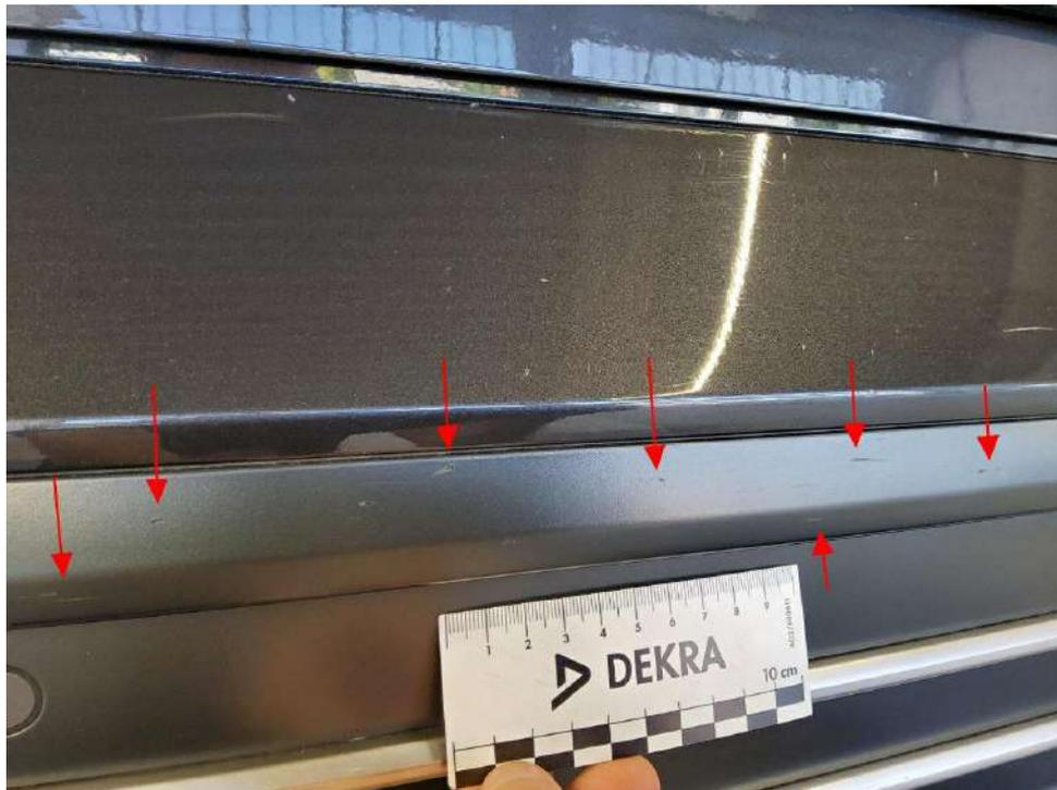
Bild 17 : Heckschürze hinten unten, zerkratzt, lackieren mit Lackaufbau
