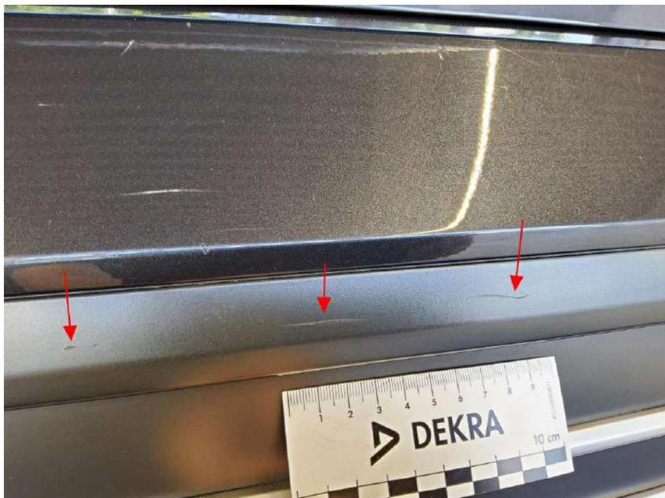
Bild 18 : Heckschürze hinten unten, zerkratzt, lackieren mit Lackaufbau
