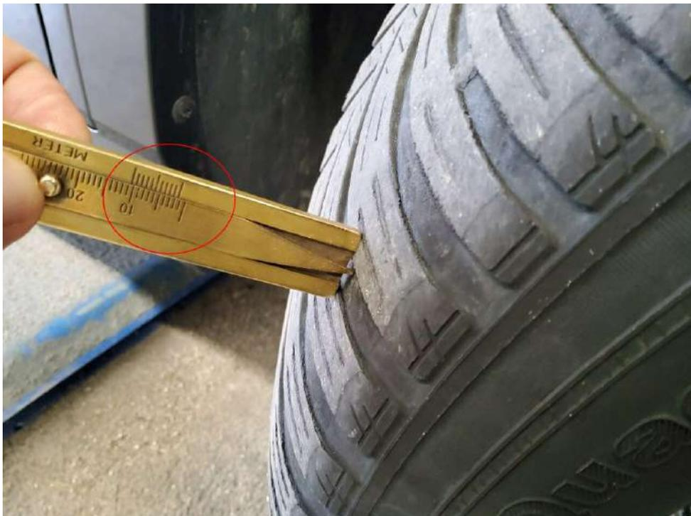
Bild 24 : Reifen vorne rechts, abgefahren
