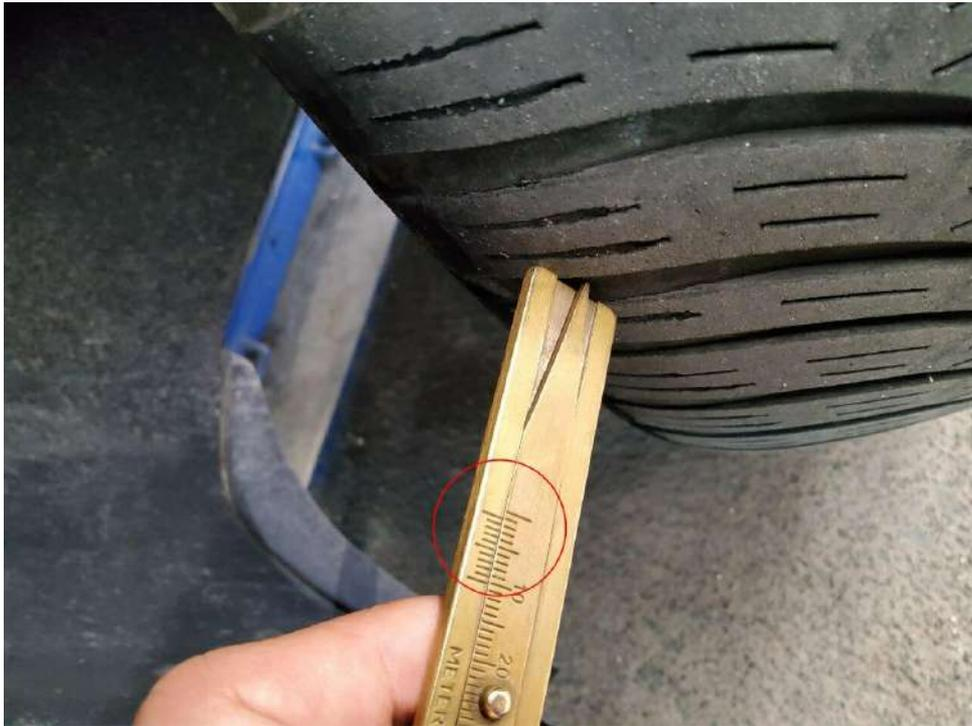
Bild 21 : Reifen vorne links, abgefahren
