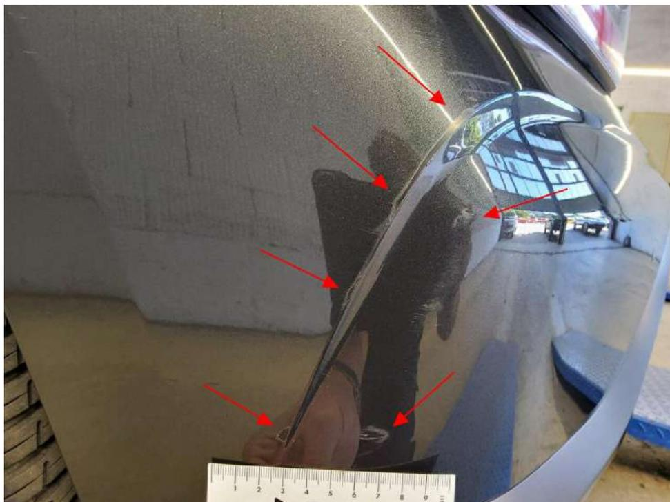
Bild 12 : Stoßfänger hinten Lackierung, verschrammt, lackieren mit Lackaufbau
