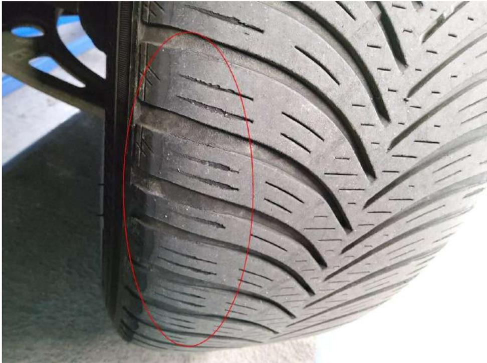
Bild 19 : Reifen vorne links, abgefahren
