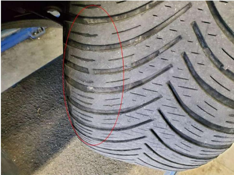
Bild 23 : Reifen vorne rechts, abgefahren
