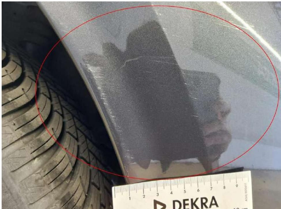
Bild 10 : Stoßfänger hinten Lackierung, verschrammt, lackieren mit Lackaufbau
