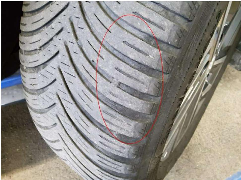
Bild 22 : Reifen vorne rechts, abgefahren
