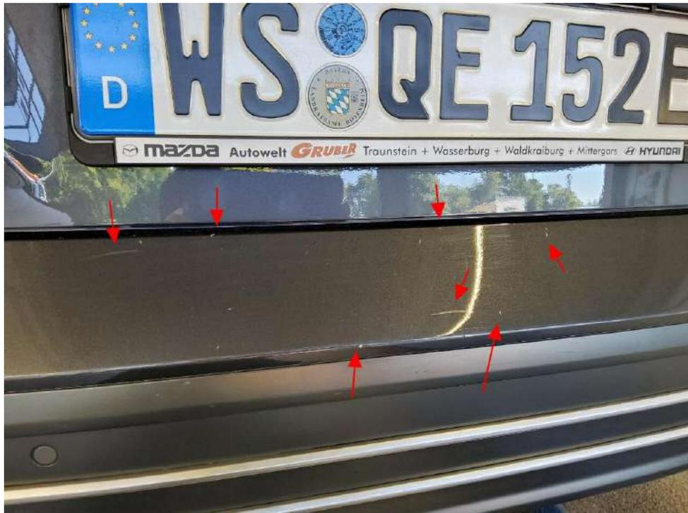
Bild 13 : Stoßfänger hinten Lackierung, verschrammt, lackieren mit Lackaufbau
