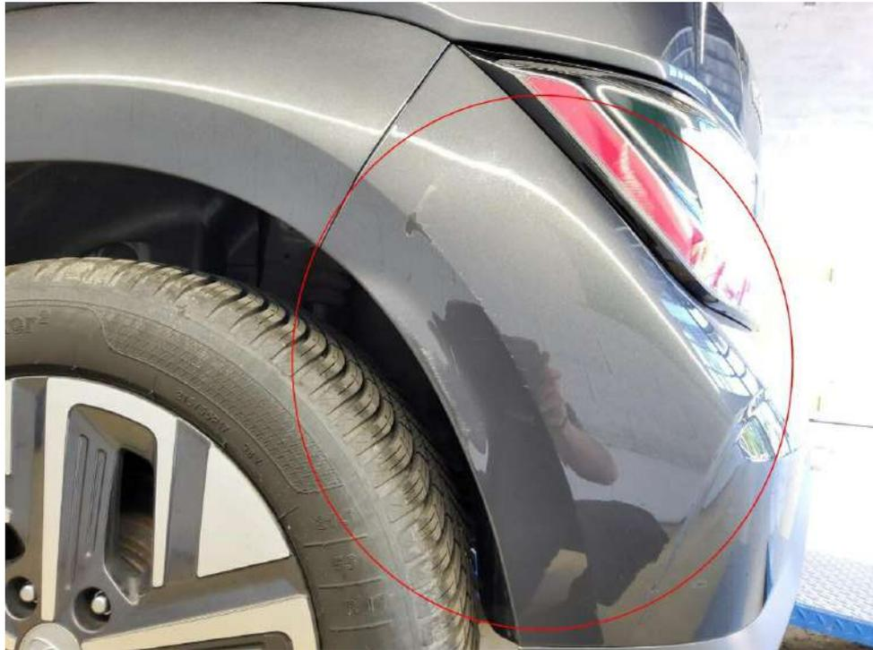
Bild 9 : Stoßfänger hinten Lackierung, verschrammt, lackieren mit Lackaufbau
