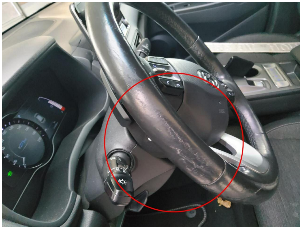
Bild 17 : Lenkrad, verschrammt, smart repair
