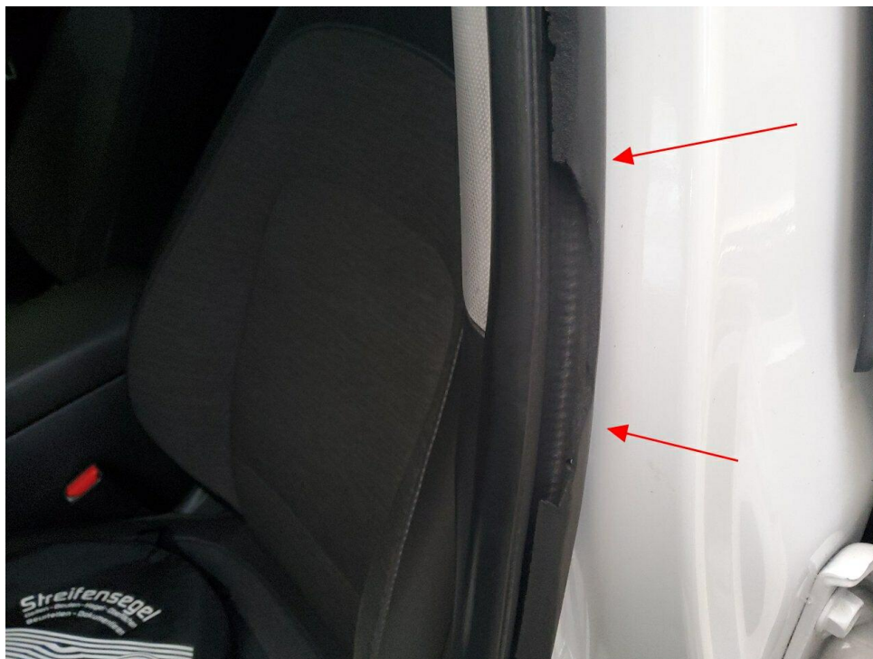
Bild 7 : Tür vorne links Dichtung, gerissen, erneuern
