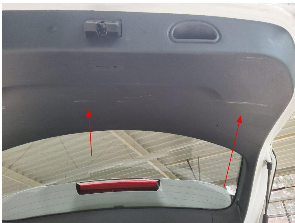
Bild 8 : Verkleidung Heckklappe, zerkratzt, Gebrauchsspur
