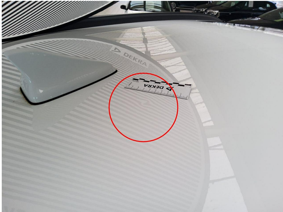
Bild 13 : Dach, eingedellt, Gebrauchsspur
