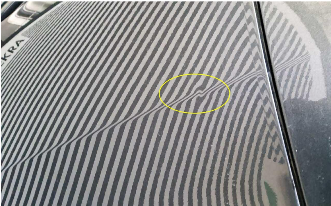
Bild 6 : Türe vorne links eingedellt
